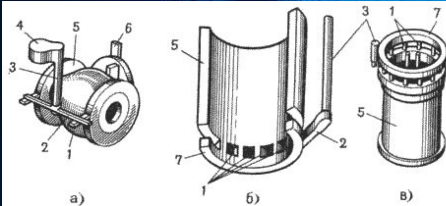
По способу подвода расплава в рабочую полость формы литниковые системы делят на: нижнюю, верхнюю, боковую.
