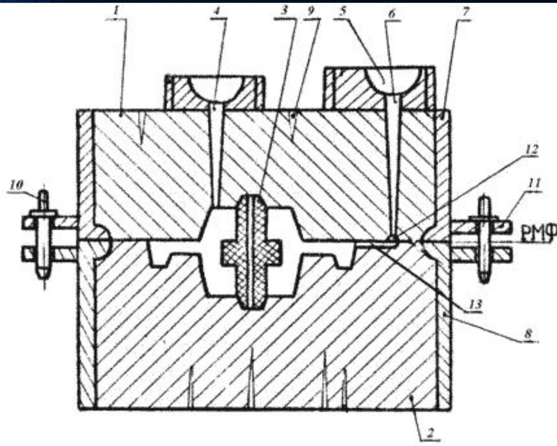
Литейная форма обычно состоит из верхней 1 и нижней 2 полуформ, которые изготавливаются в опоках 7, 8 – приспособлениях для удержания формовочной смеси. Полуформы ориентируют с помощью штырей 10, которые вставляют в отверстия ручек опок 11.
