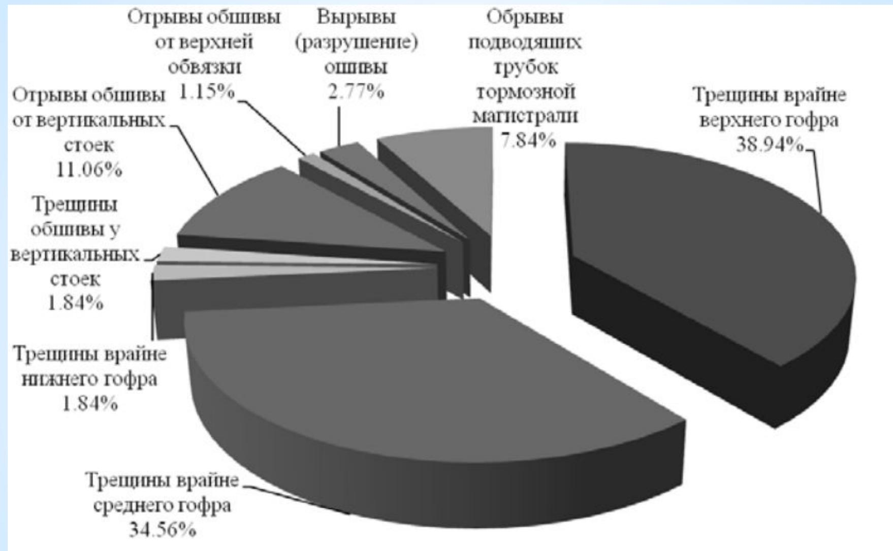
*Рис. 3. Распределение неисправностей кузовов полувагонов, поступающих на пункты разгрузки с вибрационными машинами*
