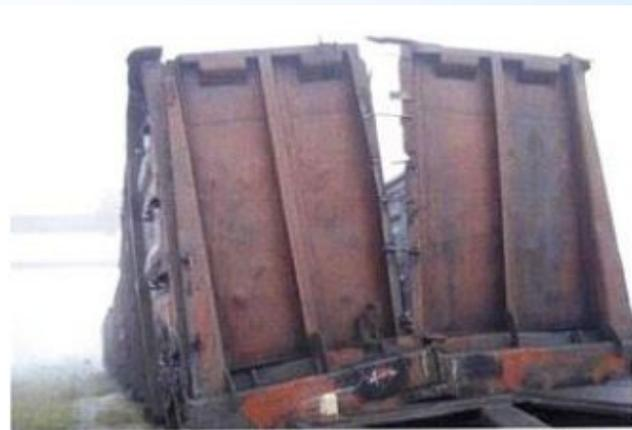
Излом концевой балки
