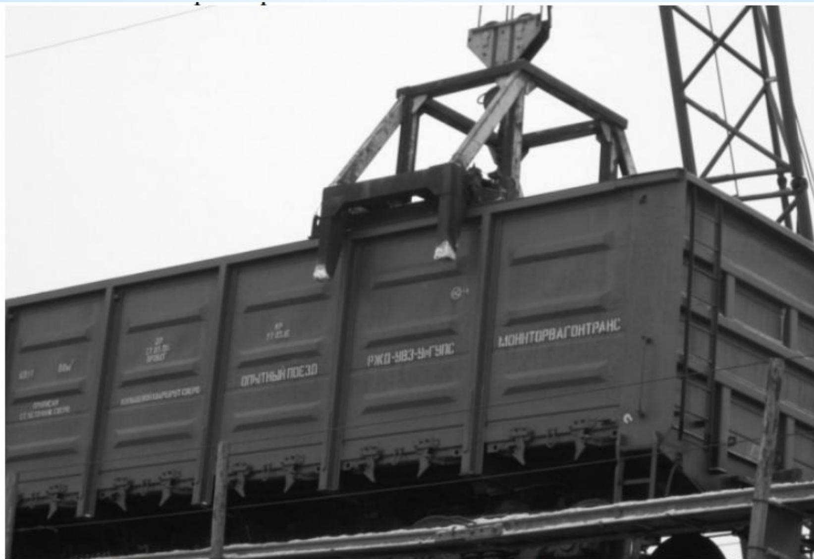
*Рис. 2. Разгрузка полувагона модели 12-132 с использованием
