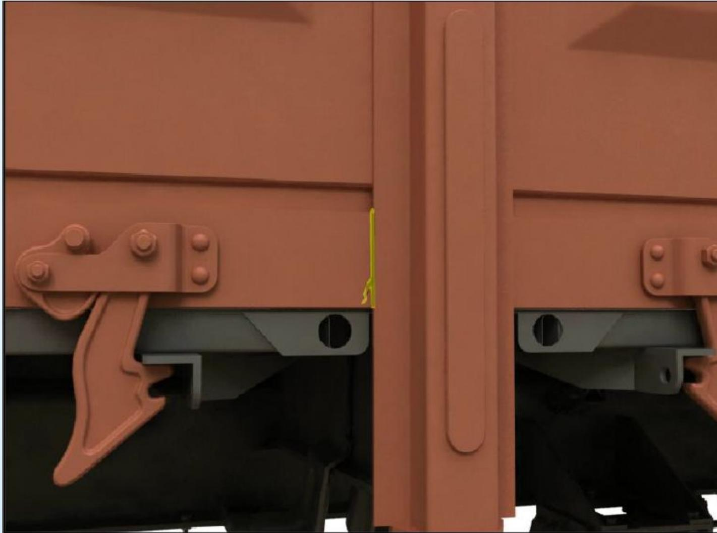
2. Перекос кузова на сторону более 75 мм, вследствие – обрыва угловой стойки, излома концевой балки, обрыва крепления двери.
