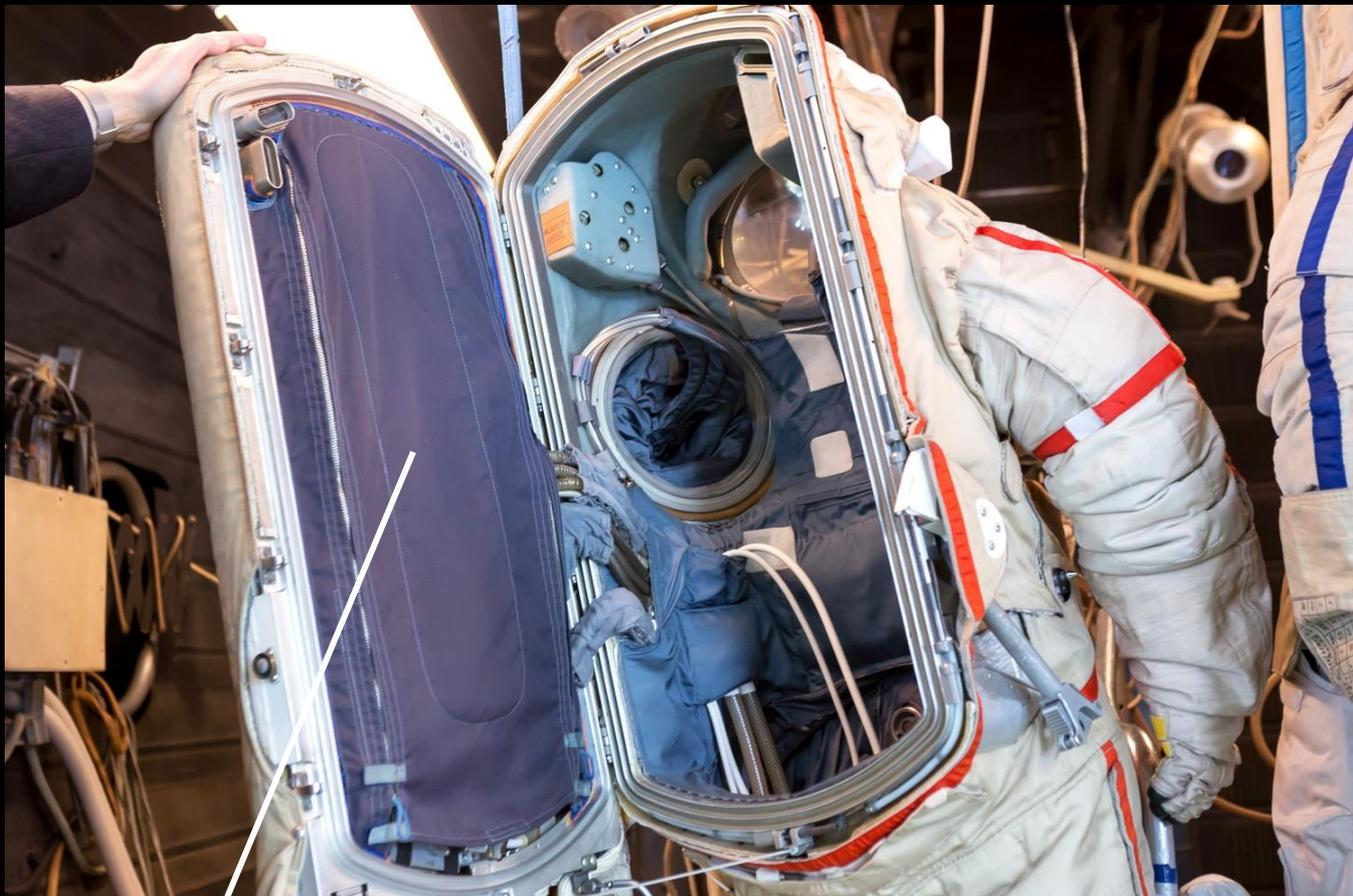
Ранец с автономной системой жизнеобеспечения
