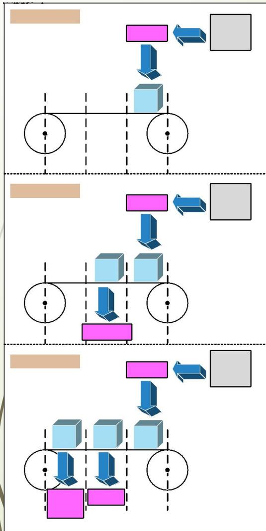
**RISC-архитектура - Reduced Instruction Set Computer** – процессор с сокращенным набором команд. Главной отличительной особенностью таких процессоров является выполнение большинства команд за **один такт процессора**. Это возможно только в **конвейерных архитектурах**.
