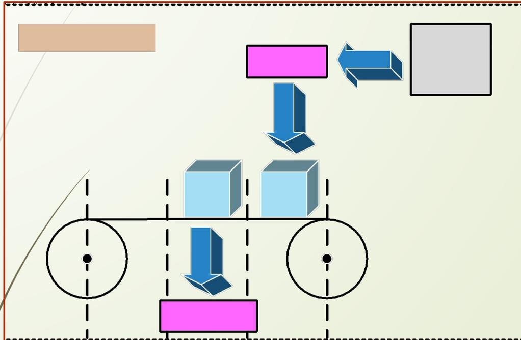
*2 такт – декодировать* код операции уже находящейся на конвейере команды - определить, что же должен делать операционный блок процессора, какая микропрограмма обработки данных должна быть запущена.
