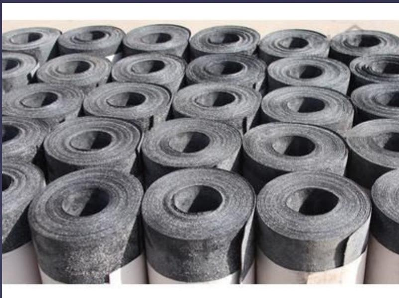
Рубероид. Его основа - кровельный картон; вяжущее - битум; верхний защитный слой отсутствует (класс П) или представляет собой крупнозернистую минеральную посыпку (класс К); нижний защитный слой - мелкозернистая посыпка.
