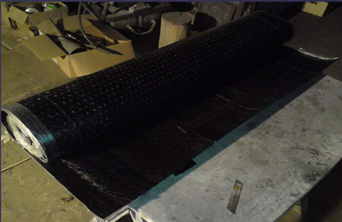
Изол. Основа - кровельный картон; вяжущее - битум с наполнителями (резина, минеральные частицы), антисептиком и технологическими добавками; защитный слой отсутствует: двусторонний оклеечный термостойкий материал, применяемый в основном для устройства пароизоляции;
