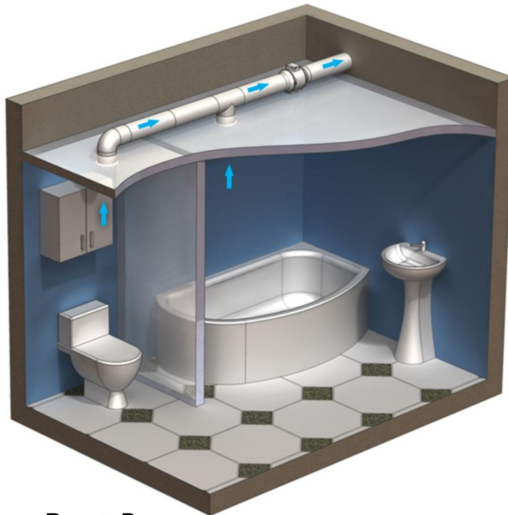
Рис. 3 Вытяжная вентиляция санузла .
