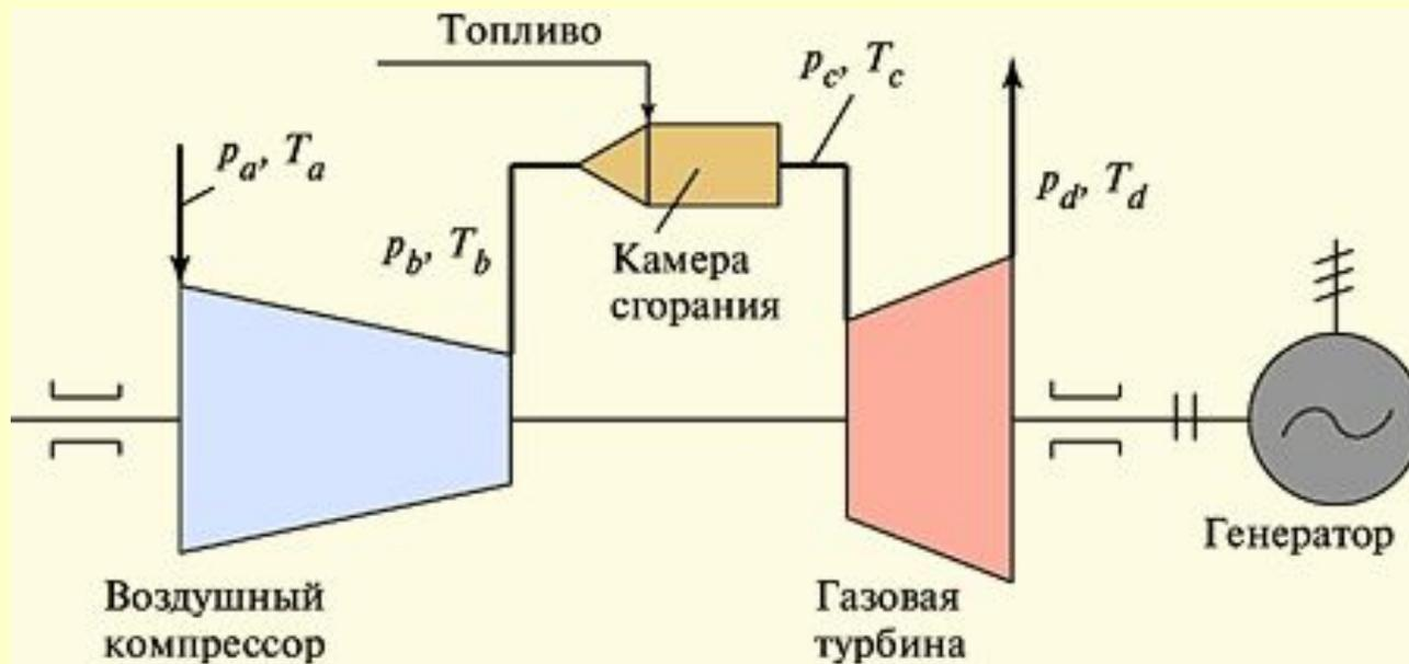
Воздушный компрессор сжимает атмосферный воздух, повышая его давление, и непрерывно подает его в камеру сгорания. Туда же топливным насосом непрерывно подается жидкое или газообразное топливо
