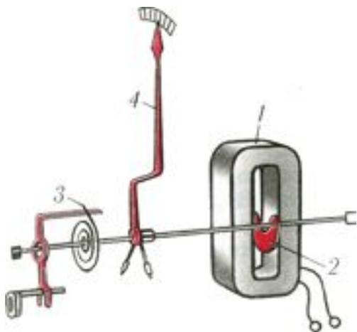
Катушка 1, по обмотке которой протекает ток. За счет этого в зазоре катушки возникает магнитное поле.
