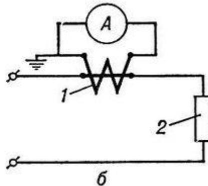
Схема включения амперметра:
