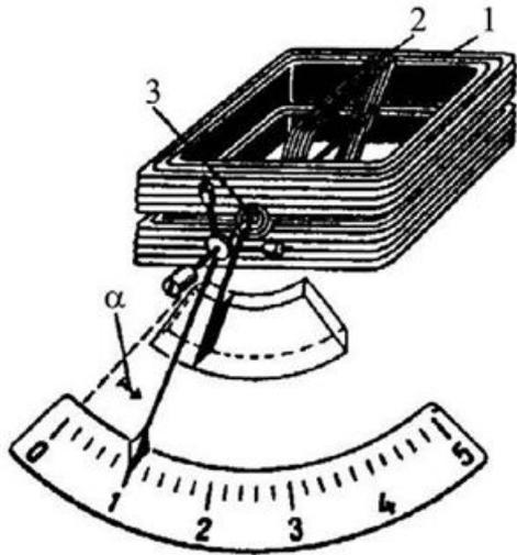
Катушка 1 неподвижная, из толстого изолированного проводника
