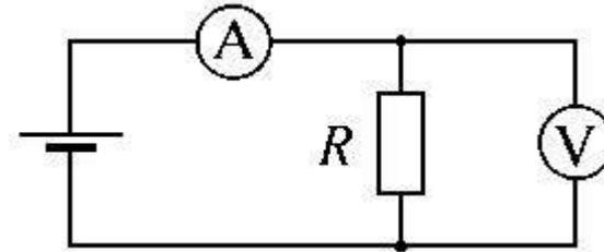
Для измерения постоянного тока обычно используются приборы магнитоэлектрической системы.
