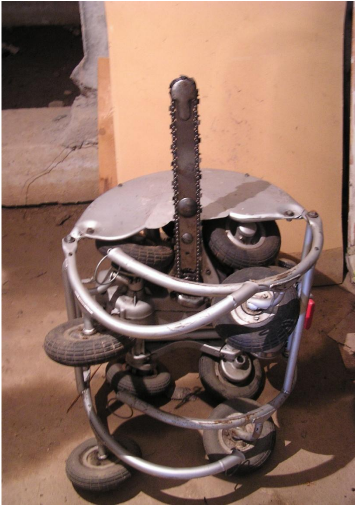
Машина KS-31 для удаления ветвей на растущих деревьях, производства Германии. Высота обрезки 13 м. Гатчинский лесхоз, Таицкое л-во, кв. 7. 1988 г.
