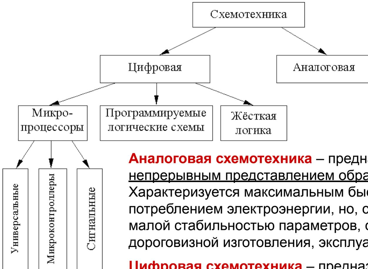
**Аналоговая схемотехника** – предназначена для работы с непрерывным представлением обрабатываемого сигнала. Характеризуется максимальным быстродействием, малым потреблением электроэнергии, но, с другой стороны, малой стабильностью параметров, сложностью и дорогостоящей изготовления, эксплуатации и ремонта.
