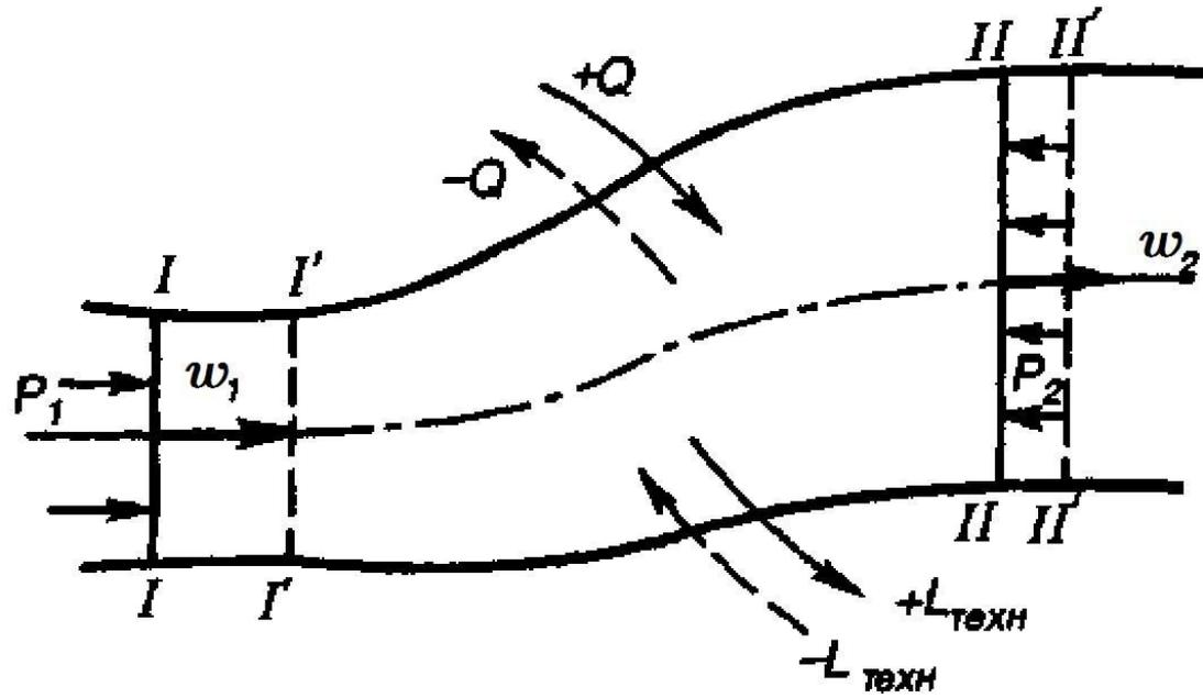
В сечении II сила  $p_2 F_2$  направлена против потока и препятствует перемещению газа. Работа этой силы равна
