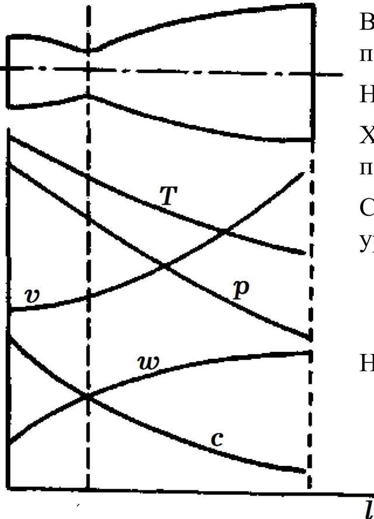
В узком сечении сопла параметры газового потока равны критическим,  $w_{кр} = c_{кр}$ .
