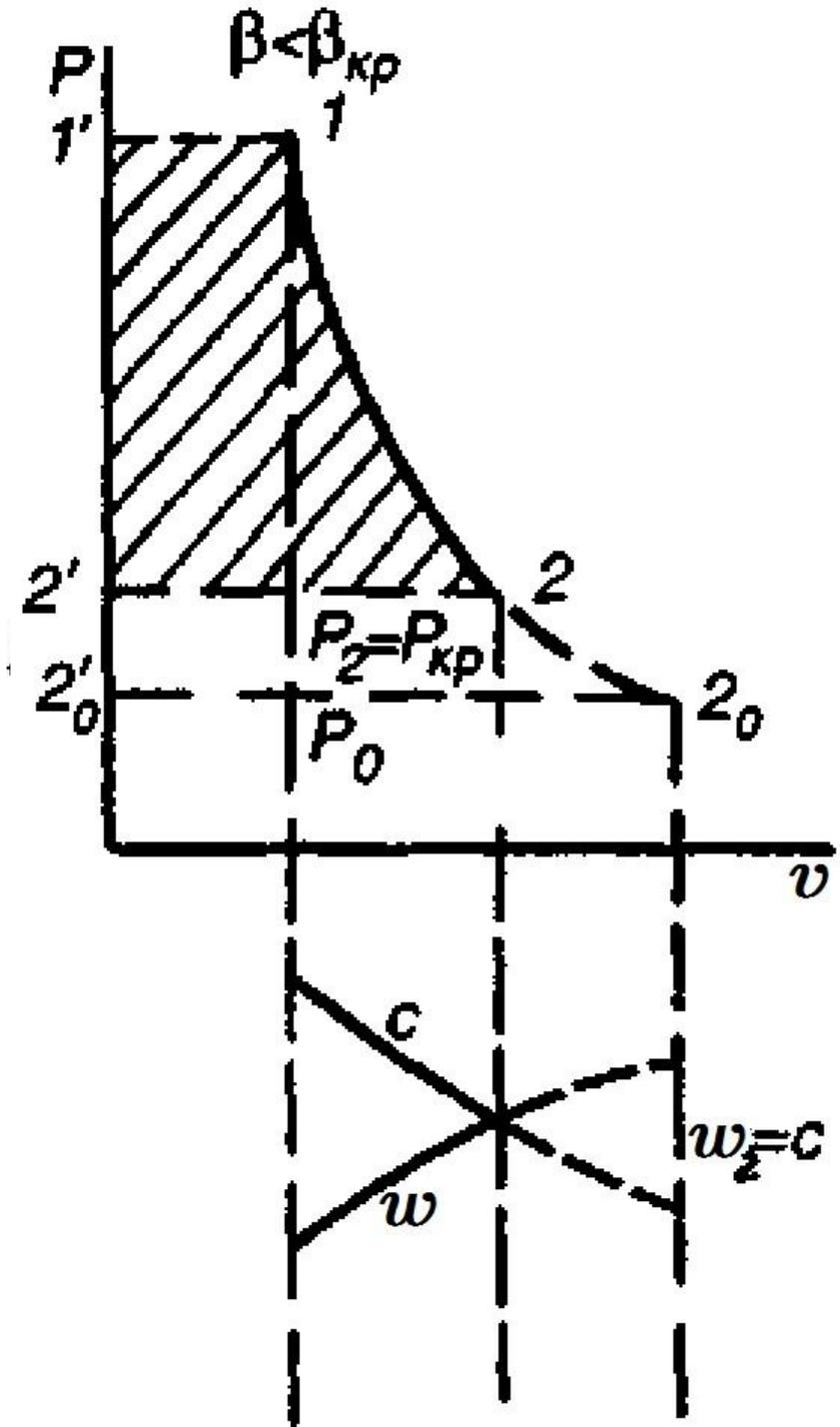
Когда  $\beta = \beta_{кр}$  и  $\beta < \beta_{кр}$ ,  $w = c_{кр}$ , скорость газа на выходе можно определить по формуле (28)
