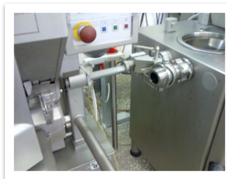
5. Выходной канал фаршасоса
