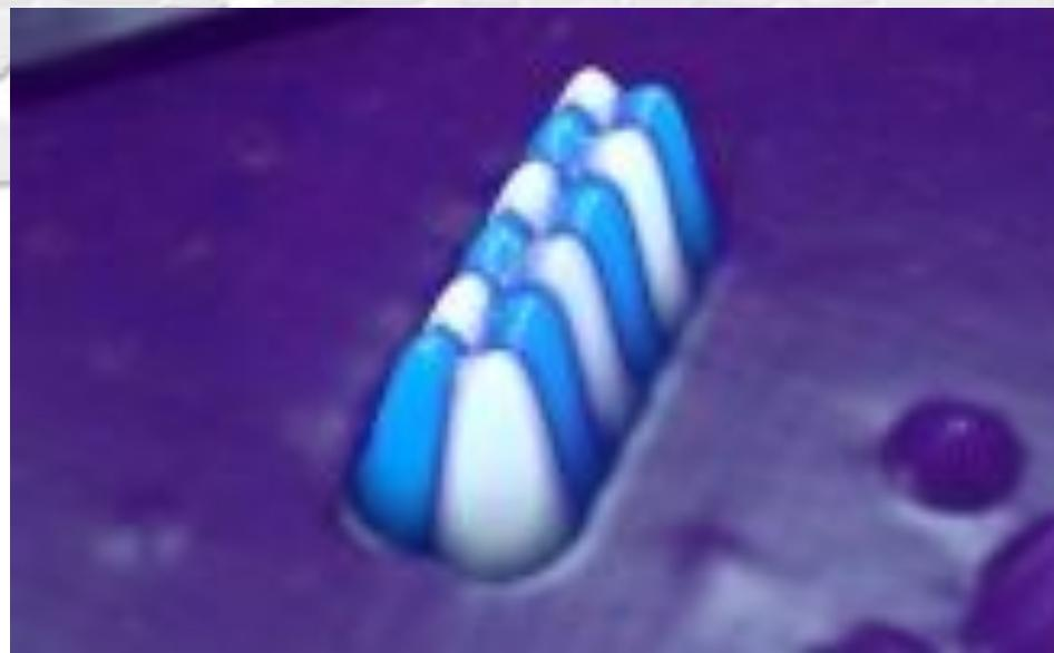
Игла туннельного микроскопа позволяет с помощью слабых электромагнитных импульсов переводить их из одного состояния в другое, записывая информацию, а еще более слабые импульсы дают возможность ее считывать
