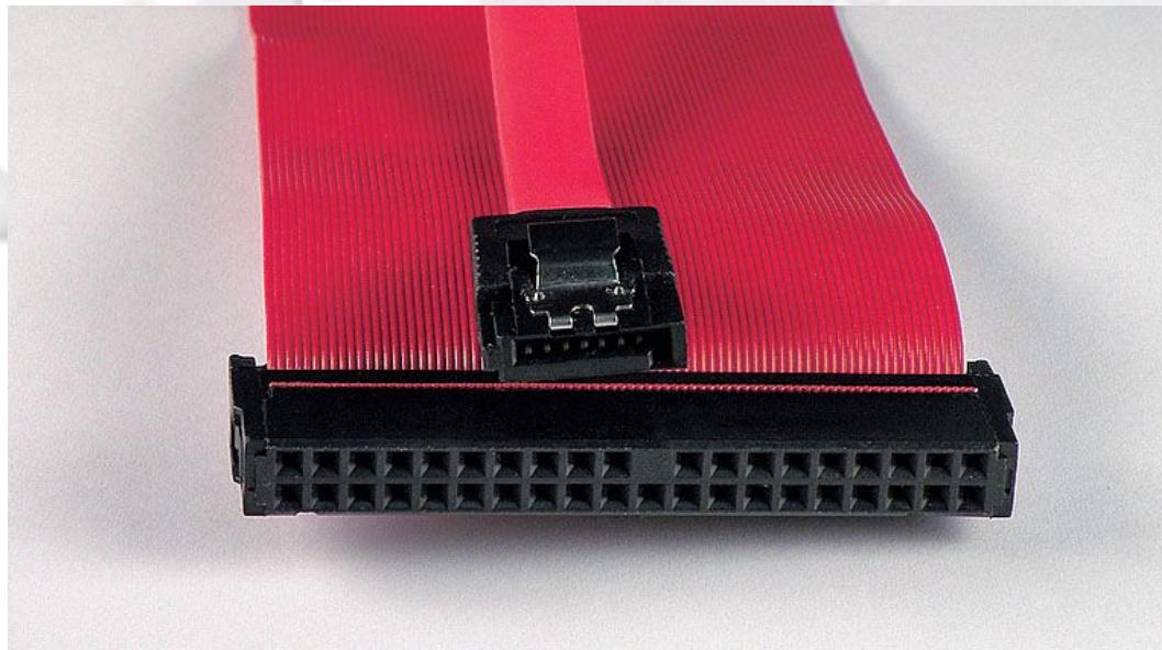
Уже при первом взгляде на диск с интерфейсом SATA становится очевидным его преимущество перед PATA – меньший размер разъема. Для передачи данных используется компактный 7 - жильный кабель, длина которого к тому же может быть увеличена до 1 м. Подключение такого диска не составит труда даже новичку.
