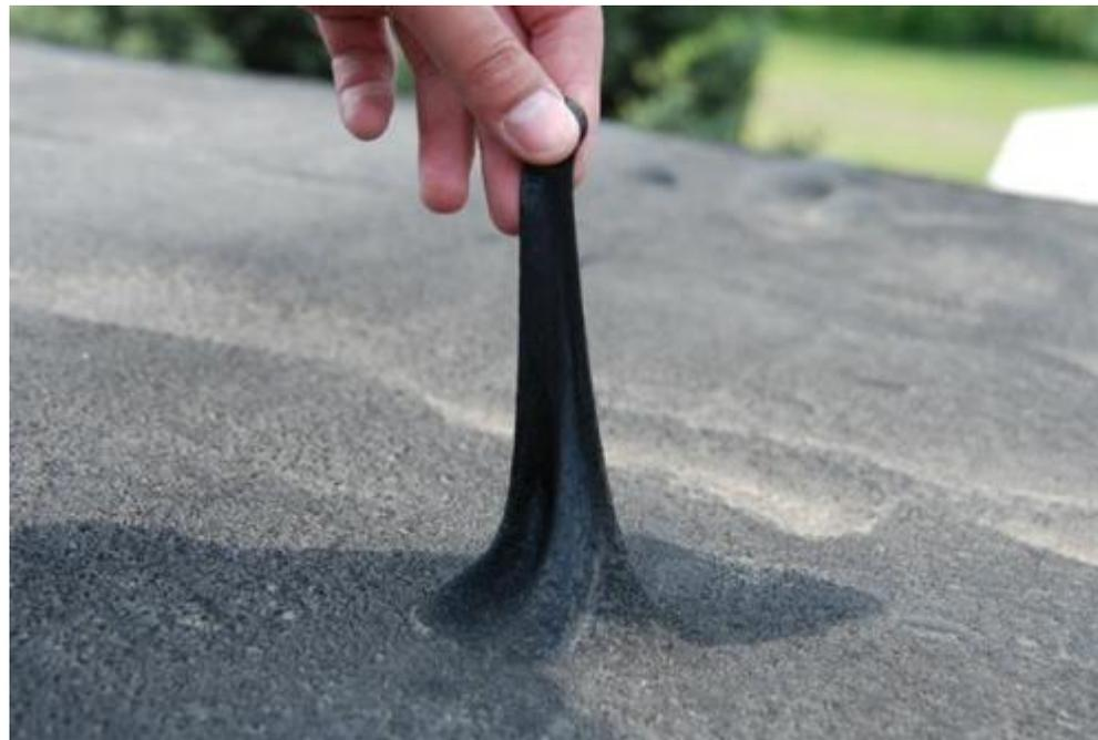
Напыление полимерно-битумной эмульсии на водной основе еще называют «жидкой резиной».
