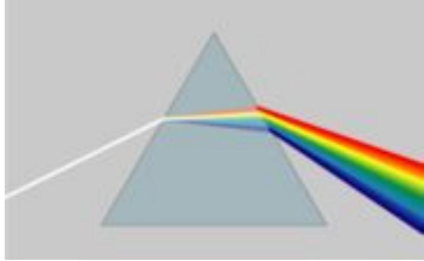
**Разложение света в спектр** вследствие **дисперсии** при прохождении через призму (опыт Ньютона)
