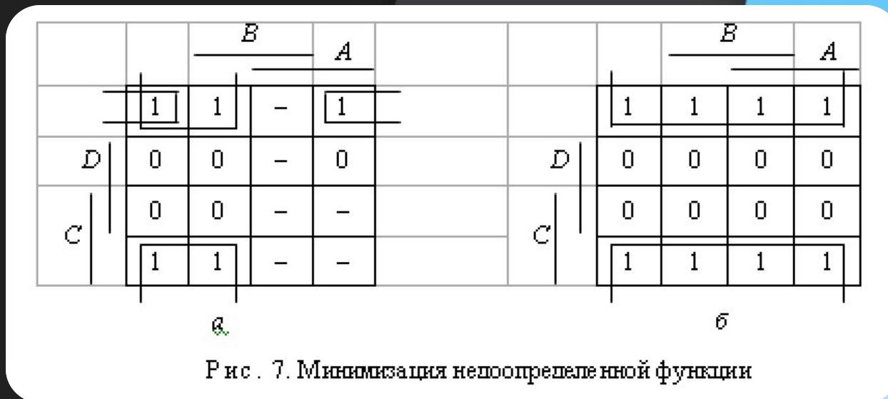
Рис. 7. Минимизация недоопределенной функции
