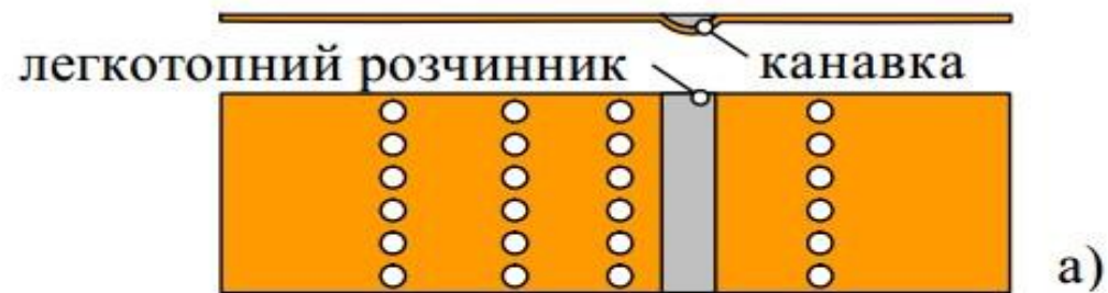
Рис. 4.5. Мідний топкий елемент з металургійним ефектом (а) та вплив металургійного ефекту на часо-струмові характеристики запобіжника (б)
