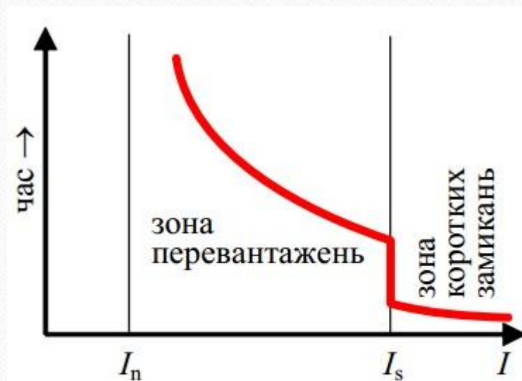
Рис. 4.15. Часо-струмова характеристика відмикача ( I – очікуваний струм у колі, rms)
