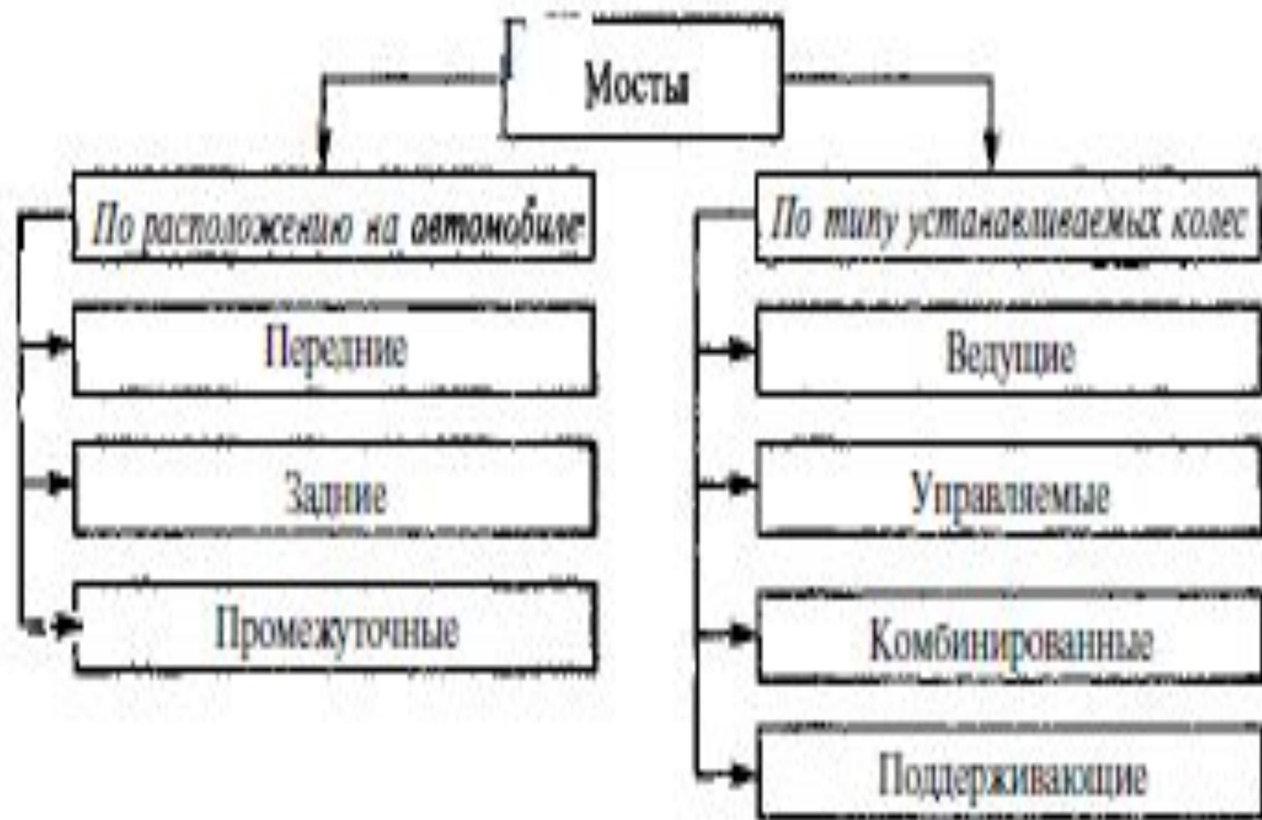
Рис. 35.1. Типы мостов автомобилей
