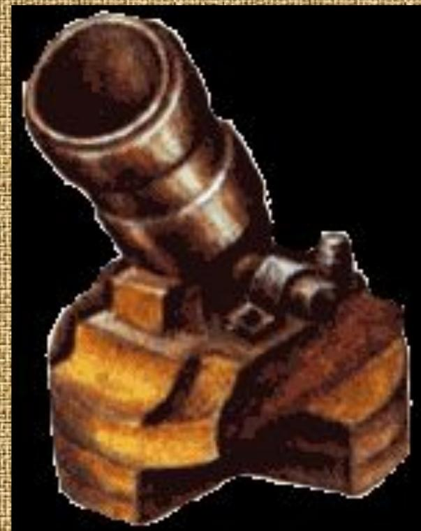
Орудия с удлиненным стволом называли **«бомбардами»**. Первоначально бомбарды изготовлялись из железных полос и скреплялись железными кольцами. Позже стволы стали делать литыми. В форме отливался ствол, а ствольное отверстие высверливалось. Орудия укладывались в деревянную колоду или в бревенчатый сруб, сзади для упора забивались деревянные сваи.
