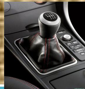
**Служит для изменения силы тяги и скорости движения автомобиля в зависимости от условий движения. Кроме того, коробка передач обеспечивает возможность движения автомобиля задним ходом и длительного разъединения двигателя и ведущих колёс**
