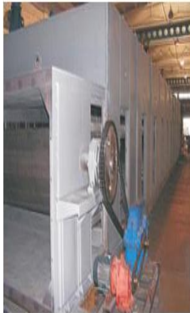
Рис. 4. Петлевая сушилка: 1 - питатель, 2 - бесконечная сетчатая лента, 3 - прижимные вальцы, 4 - цепной конвейер, 5 - направляющий роликкалорифер, 6 - автоматическое ударное устройство, 7 - разгрузочный шнек, 8 - вентилятор
