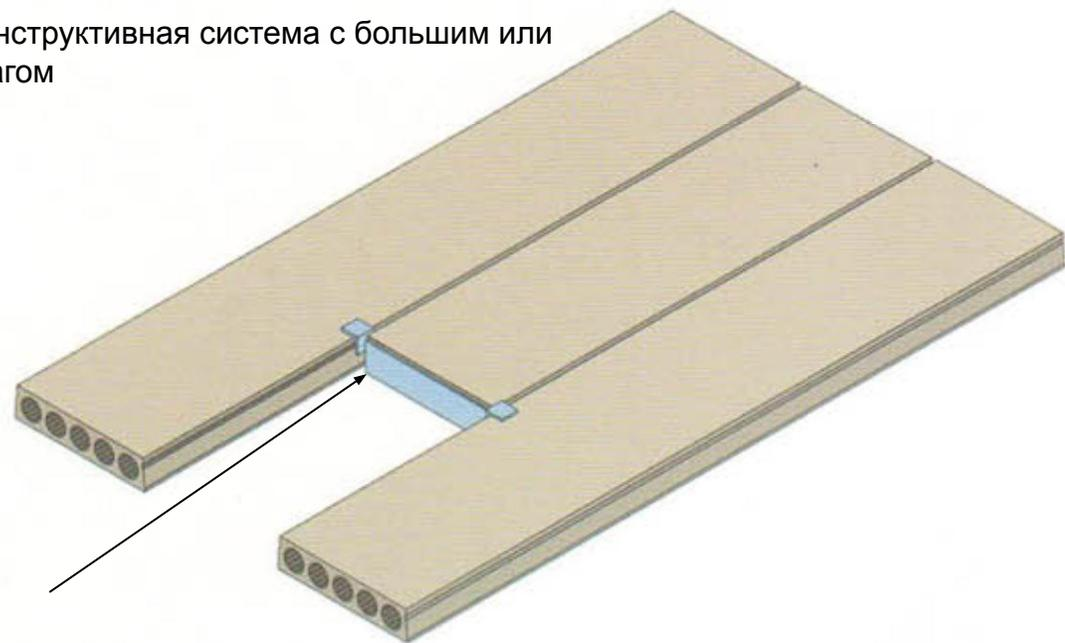
С помощью хомута, на котором держится плита, создается отверстие для вентканала и инженерных коммуникаций
