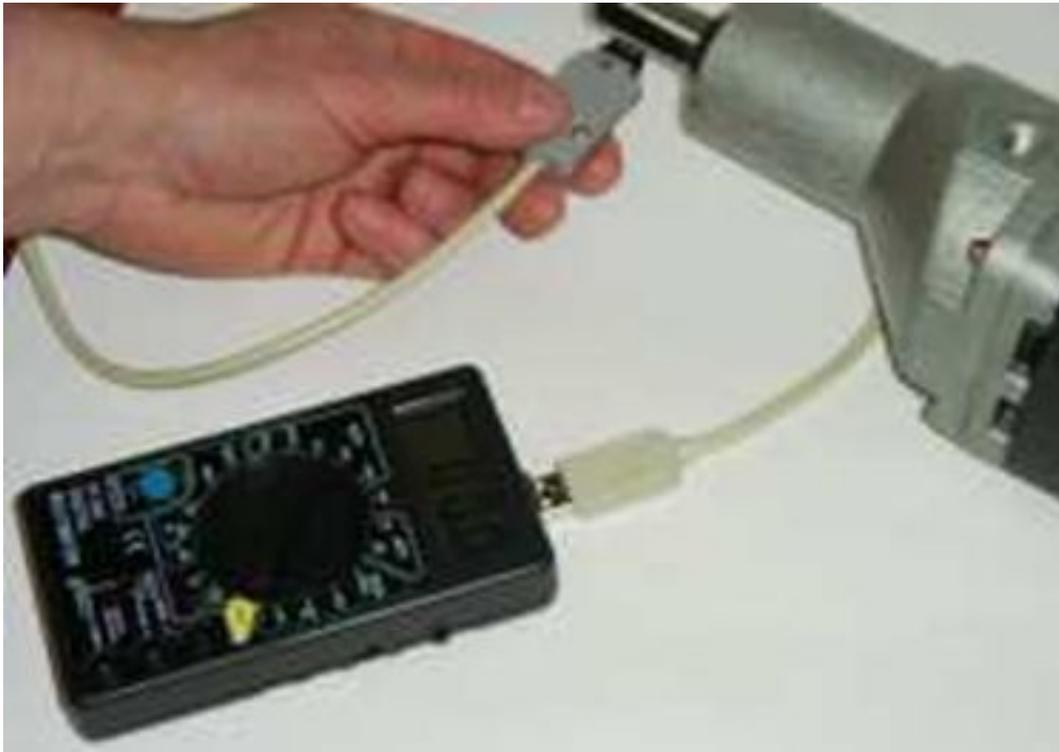
Датчик оборотов (Малогабаритный цифровой мультиметр со встроенным тахометром) M830Th предназначен для измерения частоты вращения валов механизмов и машин бесконтактным методом при помощи оптоэлектронного датчика, работающего в инфракрасном диапазоне электромагнитных волн.
