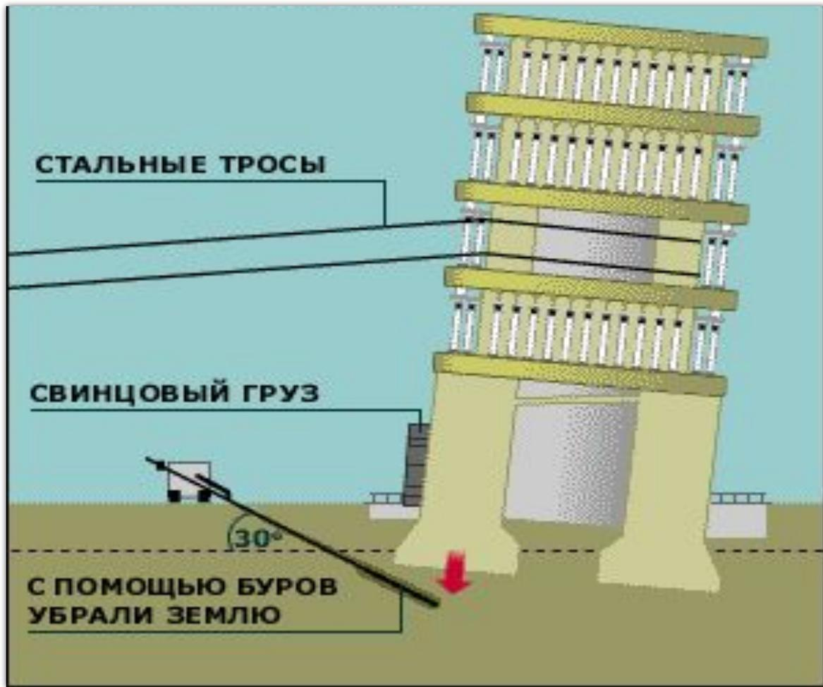
Не все сооружения стоят устойчиво. Наклон Пизанской башни известен всем. Башня наклонена на юг. Для предупреждения развития крена, на противоположную северную сторону были установлены противовесы - свинцовые пригрузы на бетонных балках и натянуты стальные тросы, закрепленные на самой башне для ее стабилизации.
