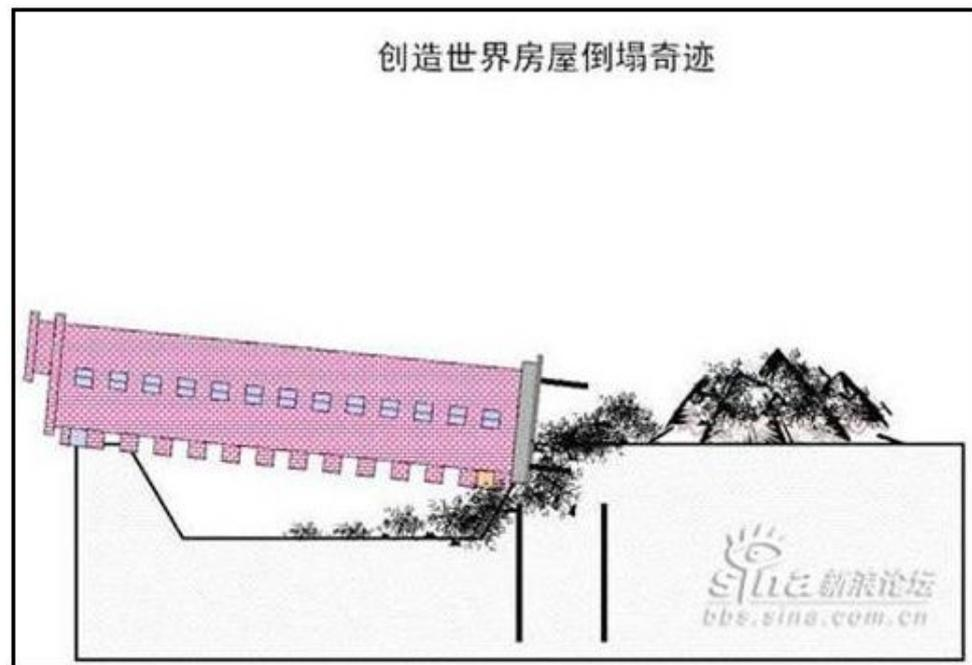
Причиной падения здания в Шанхае является отрывка котлована в непосредственной близости без принятия мер защиты в условиях отсутствия с сваях здания элементов, работающих на растяжение
