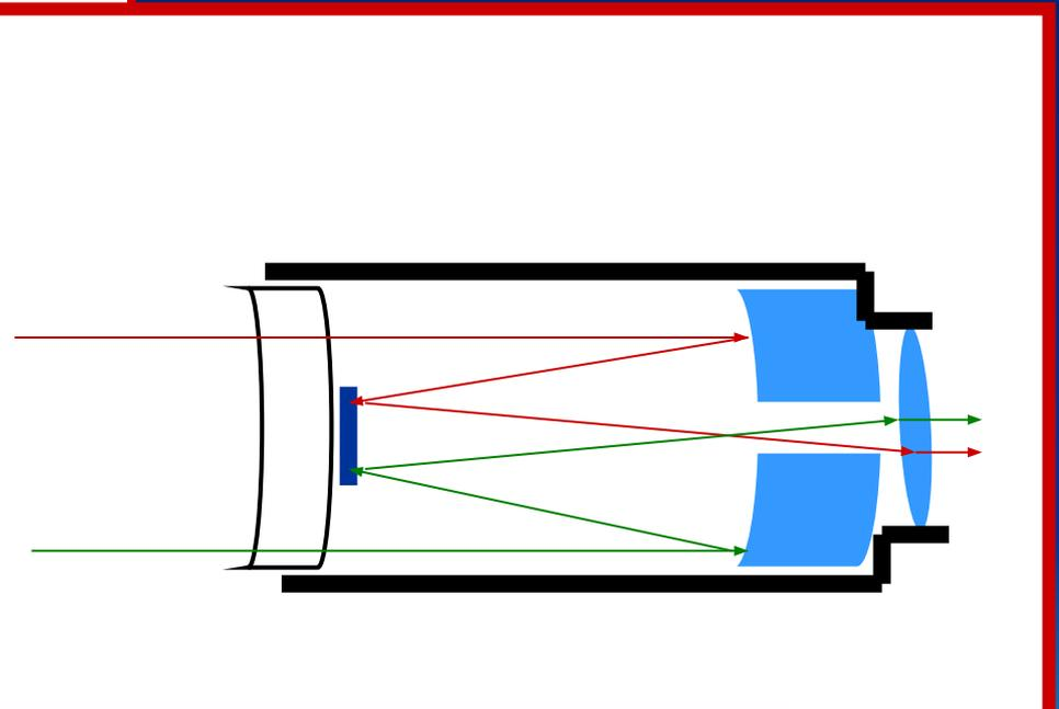
Телескоп – зеркально – линзовый – комбинация зеркал (телескоп Максутова).
