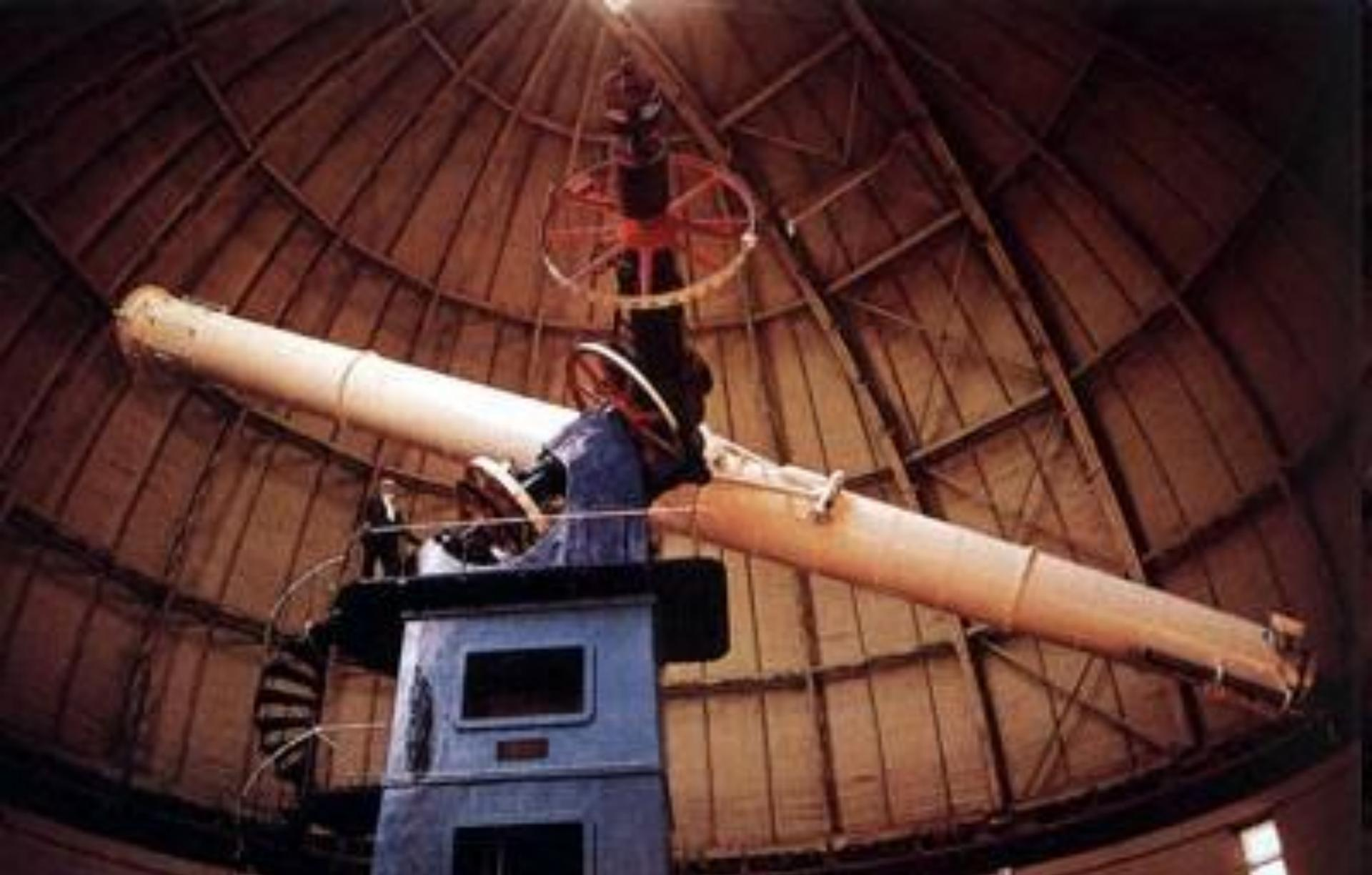
Самый большой рефрактор в мире, который находится в Йеркской обсерватории в США, имеет линзу диаметром в 1 м.
