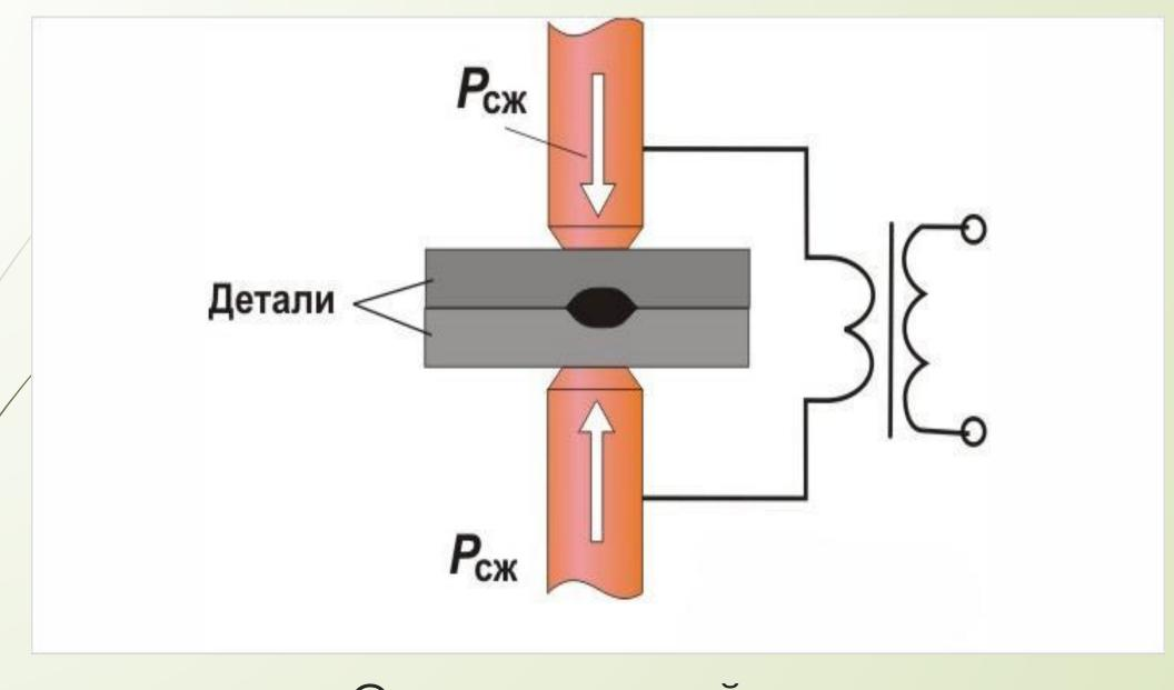
Схема точечной сварки
