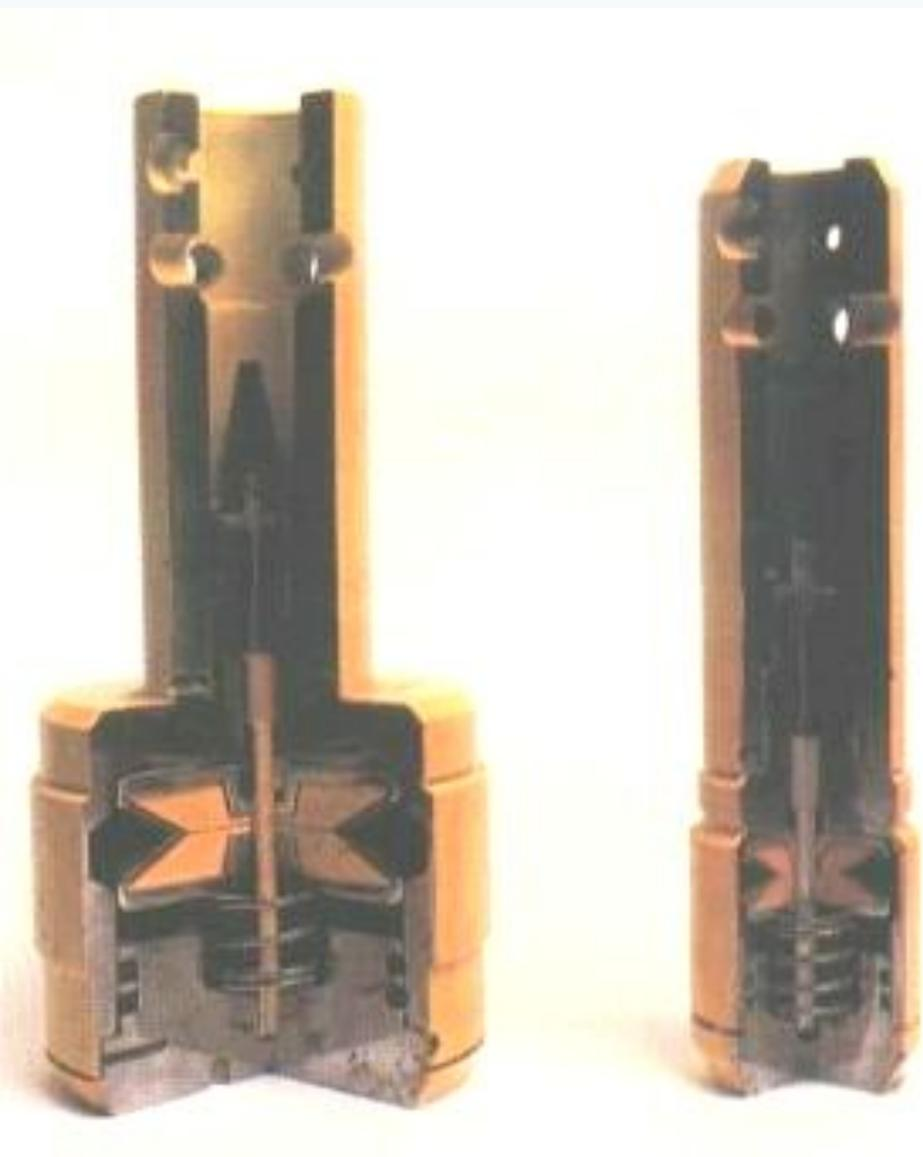
Назначение - перерезание насосно-компрессорных, обсадных, а также бурильных труб с наружу высаженными концами в скважинах с гидростатическим давлением до 80 МПа и температурой до 150°С
