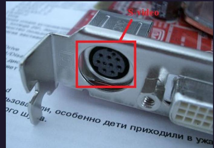
DVI (Digital Visual Interface) — наиболее распространенный интерфейс, который бывает в трех вариантах: DVI-D (цифровой), DVI-A (аналоговый), DVI-I (комбинированный). В дискретных видеокартах обычно присутствует DVI-I, как наиболее универсальный.
