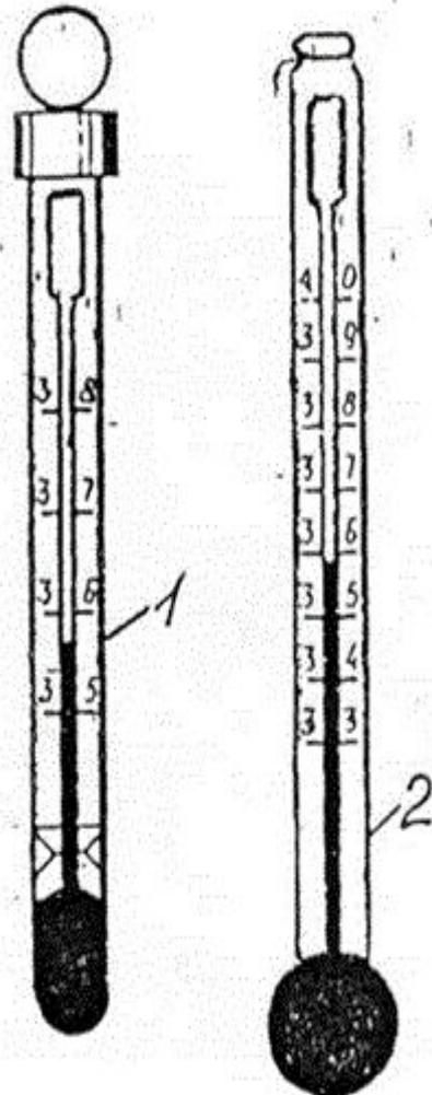
Для определения малых скоростей движения воздуха в помещениях (до 1- 2 м/с) применяют *кататермометры*, а для больших скоростей (до 50 м/с) - *анемометры*.
