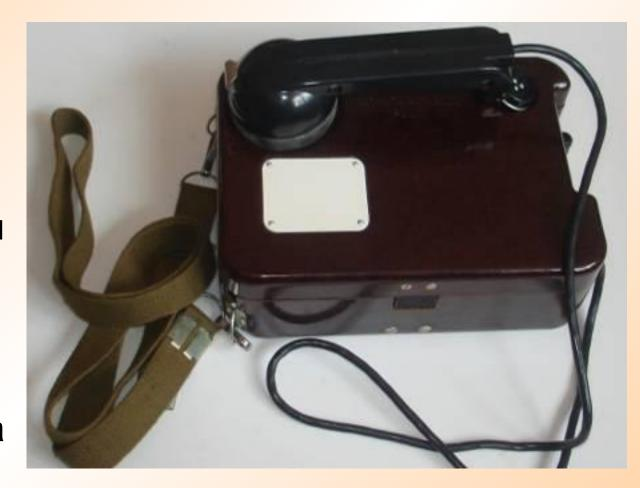
Дальность связи по кабелю П-274М - 35-40 км. (при нажатии рычага «У» (включение усилителя приема) дальность приема увеличивается на 30-35 %).
