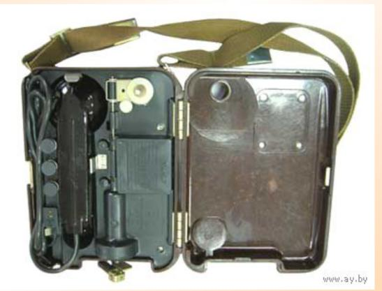
в) проверить разговорную цепь — взять микротелефон и, нажав разговорный клапан РК, подуть в микрофон.
