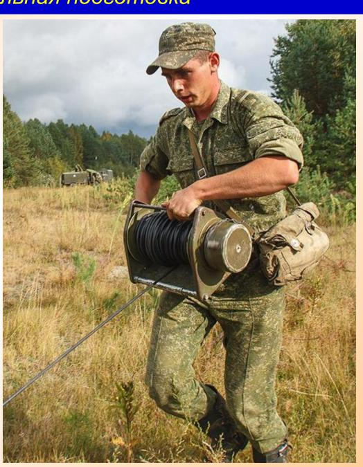
Кабель П-274 в отличие от стационарных сравнительно легок, позволяет быструю прокладку и снятие и пригоден для многократного использования.
