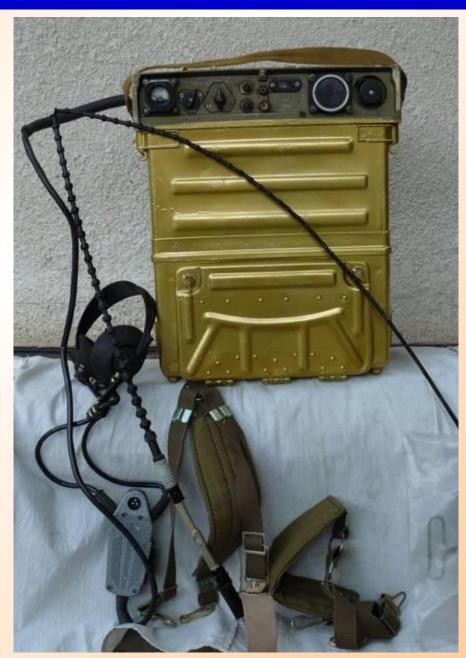
Диапазон 20-52 МГц, установка частоты с помощью механизма установки частоты осуществляется через 1 МГц по шкале, а в пределах мегагерца - с помощью электронно-счетного устройства через 1 кГц по табло.
