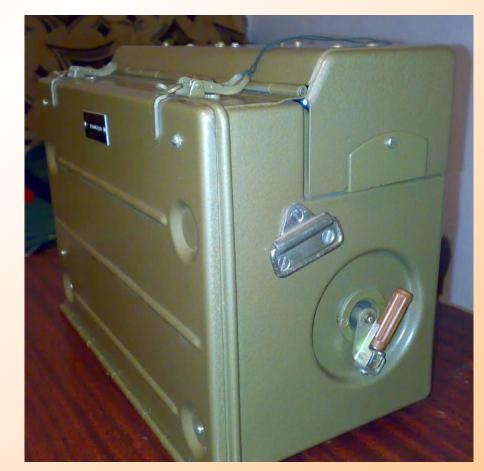
Полевой ручной телефонный коммутатор П-193 с индукторным вызовом предназначен для обеспечения телефонной связи с удаленными и местными абонентами.
