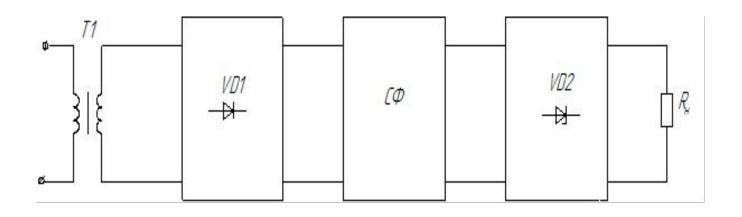
Функциональная схема по сравнению со структурной более подробно раскрывает функции отдельных элементов и устройств. Функциональные части и связи между ними на схеме изображают в виде условных графических обозначений, установленных соответствующими ГОСТами ЕСКД. Отдельные функциональные части допускается изображать в виде прямоугольников. Графическое построение схемы должно давать наиболее наглядное представление о последовательности процессов, иллюстрируемых схемой.
