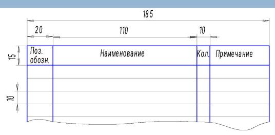
Данные об элементах, входящих в состав изделия и изображенных на схеме, записывают *в перечень элементов*, который помещают на первом листе схемы или выполняют в виде самостоятельного документа.
