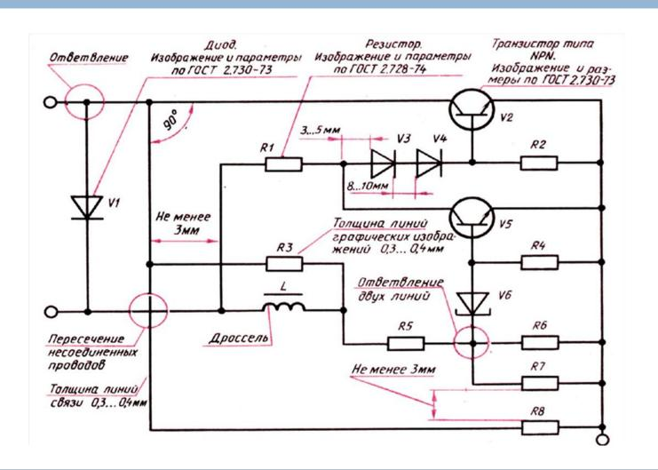
Схема соединений (монтажная) — схема, показывающая соединения составных частей изделия (установки) и определяющая провода, жгуты, кабели или трубопроводы, которыми осуществляются эти соединения, а также места их присоединения и ввода (зажимы, разъемы, сальники, проходные изоляторы, фланцы и т. п.).
