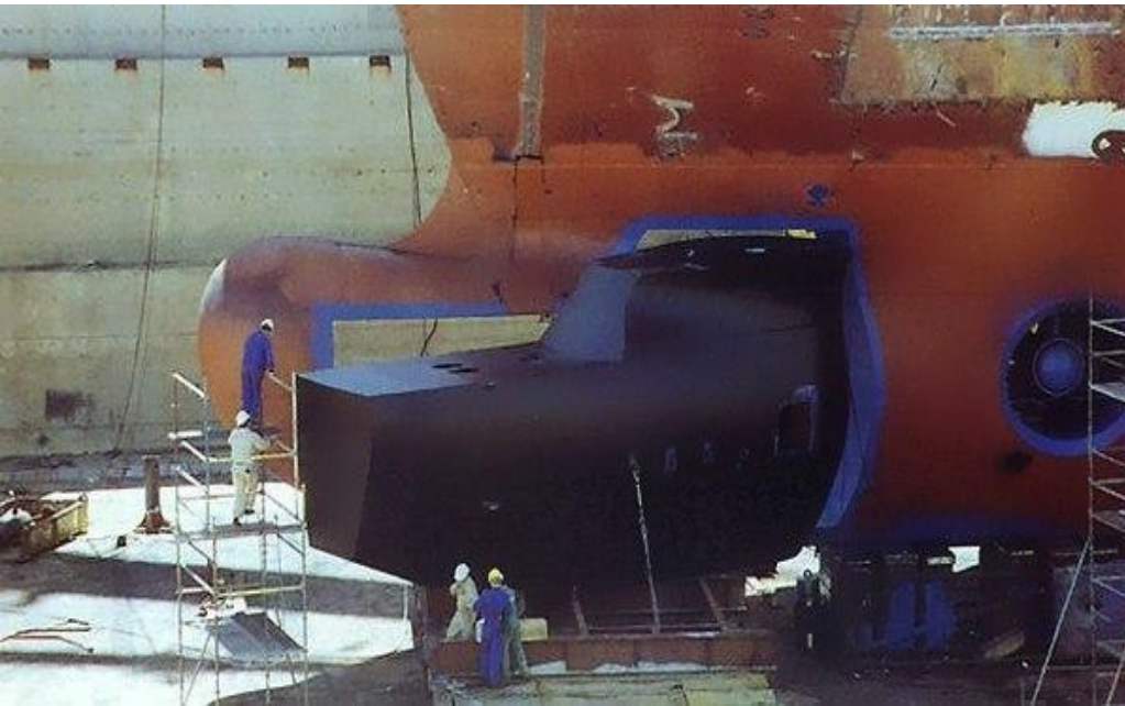
Паром «Skåne» имеет нетипичную рулевую систему, состоящую из двух рулей - кормового и носового.
