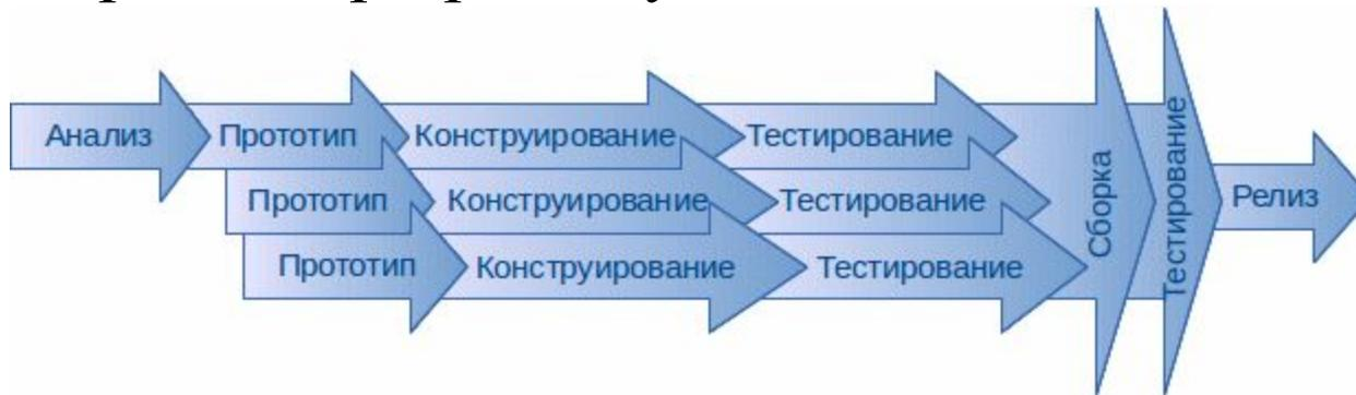
Рисунок 4 – Инкрементное прототипирование
