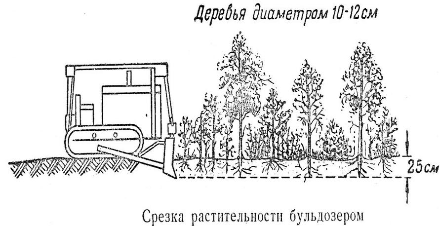
Кустарник и мелкие деревья срезают кусторезами и бульдозерами. Очистку дорожной полосы от леса и кустарника производят на ширину, равную расстоянию между наружными бровками кюветов, увеличенную на 1 м с каждой стороны дороги.
