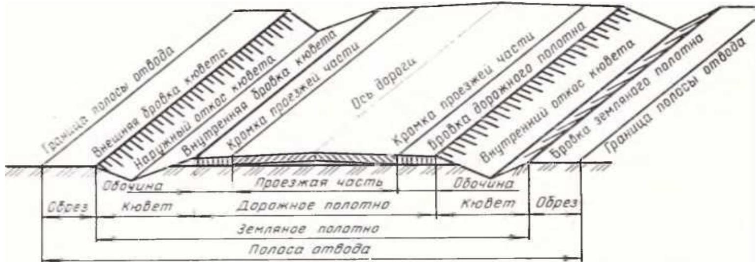
Рис. 1.4.1. Основные элементы конструкции военных автомобильных дорог
