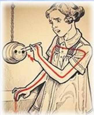
—это сила тока, протекающего по телу. Она определяется законом Ома, а значит зависит от напряжения и сопротивления.
