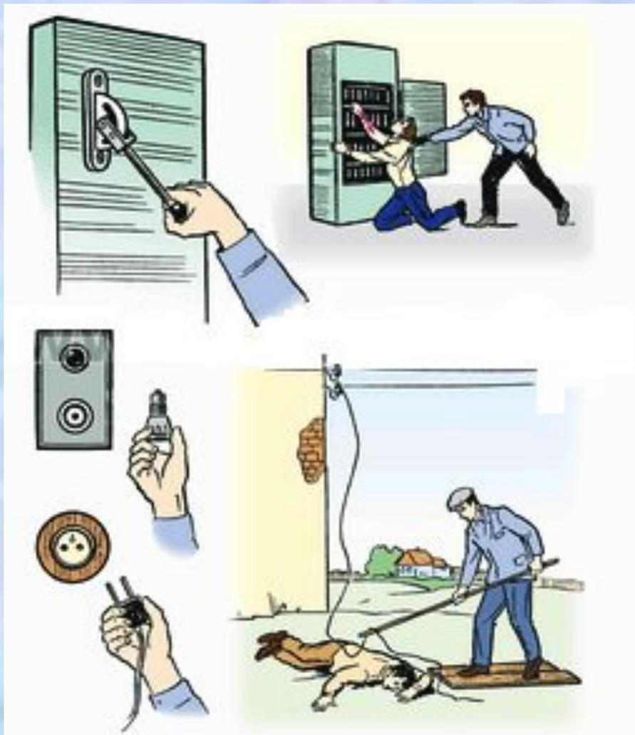
Если вы увидите лежащий на земле провод – ни в коем случае нельзя к нему приближаться и убегать от него, опасная зона может быть от 5-8 метров вокруг точки соприкосновения провода с землей и больше, в зависимости от класса напряжения линии и состояния земли (мокрая земля увеличивает пространство растекания электрического тока). Поэтому, не торопясь, не отрывая ноги друг от друга (маленькими шагами) покинуть это пространство.
