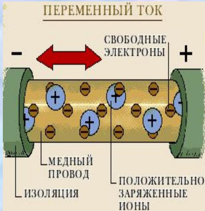
Если **электроны** в цепи периодически изменяют направление движения на обратное, такой **ТОК** называется переменным. Его вырабатывает электрогенератор переменного тока.
