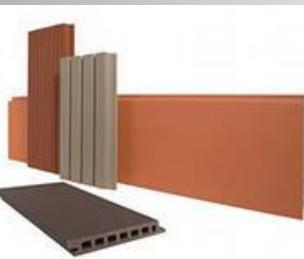
**Крупноразмерные облицовочные плиты** универсального назначения выпускаются глазурованные и неглазурованные с гладкой, шероховатой или рифленой поверхностью. Плиты имеют водопоглощение менее 1% и морозостойкость 50 циклов и более. Изготавливаются квадратной или прямоугольной формы длиной 490, 990, 1190 мм, шириной 490 и 990 мм и толщиной 9-10 мм.
