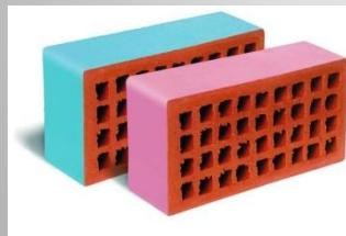
Глазурь – стекловидное покрытие толщиной 0,1-0,2 мм, нанесенное на изделие и закрепленное обжигом. Глазури могут быть прозрачными и глухими (непрозрачными) различного цвета. Для изготовления глазури используют: кварцевый песок, каолин, полевой шпат, соли щелочных металлов.
