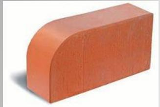
Лицевые кирпичи и камни выпускаются тех же размеров и форм, что и обычные, и отличаются более высокой плотностью и однородностью цвета. Производятся по прочности марок 75, 100, 125, 150, а по морозостойкости не менее 25.
