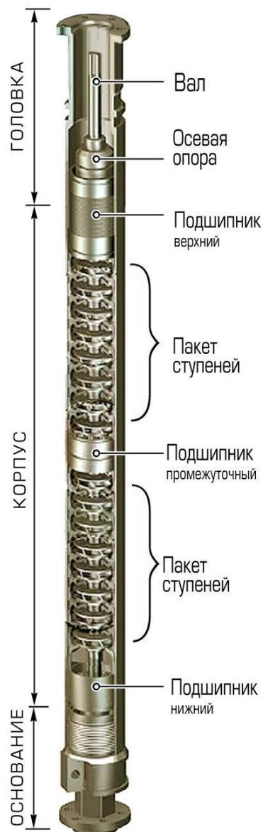
Погружной центробежный насос - состоит из большого числа **ступеней - рабочих колес и направляющих аппаратов**, заключенных в стальной корпус в виде трубы.
