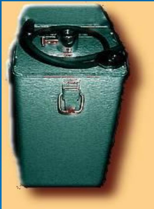
▣ Предназначен для качественного и количественного определения содержания АХОВ-хлора, аммиака, сероводорода, сернистого ангидрида, окиси углерода, окислов азота, бензола, толуола, ацетона, ацетилен, этилового эфира, бензина, углеводородов нефти и др. в воздухе производственных помещений и на территории химических предприятий.
