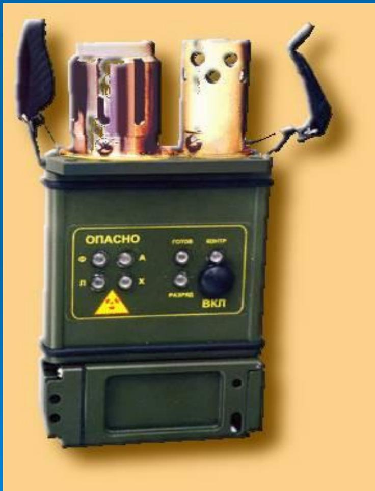
▣ Предназначен для обнаружения в воздухе специальных веществ (СВ) и сильнодействующих ядовитых веществ (СДЯВ), таких как хлор и аммиак.
