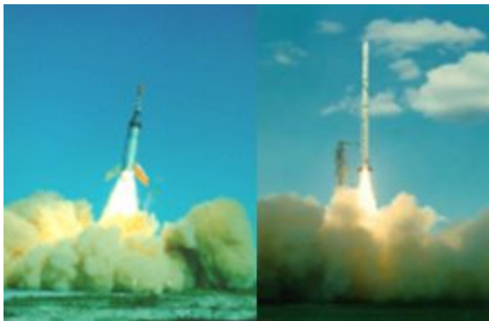
Испытания системы спасения Меркури и тепловой защиты корабля Аполлон на ракете «Скаут»
