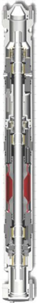
Разработано два варианта конструкций гидрозащит для двигателей унифицированной серии: открытого типа – П92; ПК92; П114; ПКП4 и закрытого типа – П92Д; ПК92Д; (с диафрагмой) П114Д; ПКП4Д.
