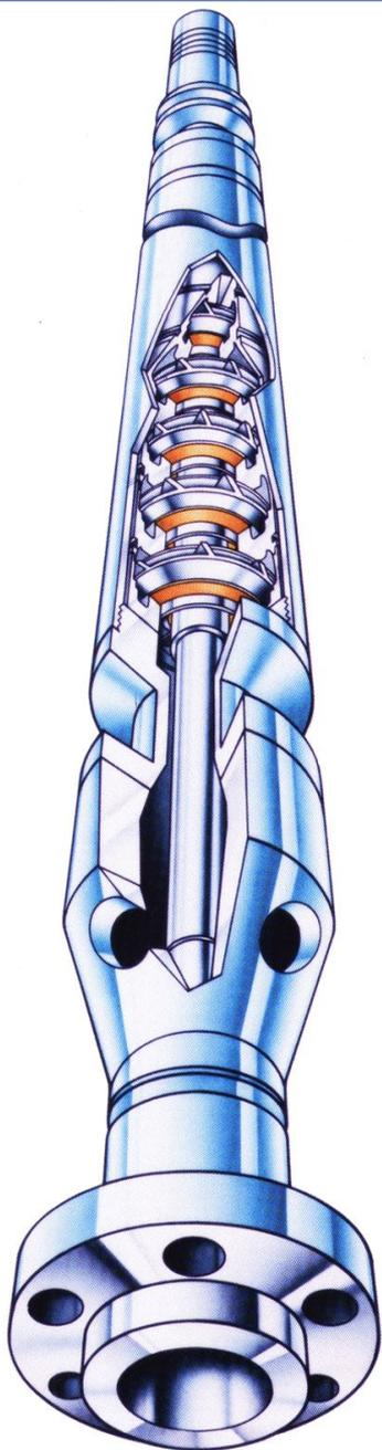
**Обратный клапан** предназначен для удержания откачиваемой жидкости в подъёмных трубах при остановке насоса. Благодаря этому клапану насос запускают в режиме, близком к режиму насоса при закрытой задвижке, что уменьшает пусковую мощность. Кроме того, при кратковременных остановках исключается возможность запуска насоса при обратном вращении вала, а это может произойти, если жидкость будет сливаться из труб. Обратный клапан ввинчен в модуль – головку насоса.
