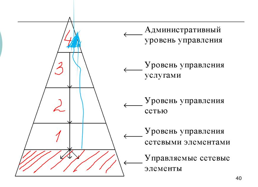
Уровень управления элементами **Element Management Layer, EML** сети (нижний уровень управления) включает в себя контроль, отображение параметров работы, техническое обслуживание, тестирование, конфигурирование применительно к отдельным элементам или их классам и атрибутам.
