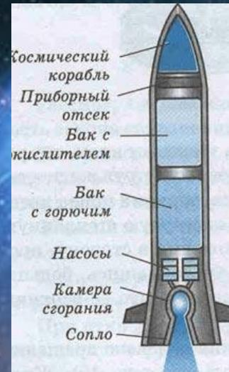
Реактивный двигатель – это двигатель, преобразующий химическую энергию топлива в кинетическую энергию газовой струи, при этом двигатель приобретает
