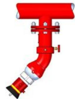
**Лафетные стволы устанавливаются на кольцевом противопожарном водопроводе Ду 200 по периметру автотрансформатора на расстоянии не менее 2,55м, в соответствии с требованиями ПУЭ, см. рисунок. Размещение стволов обеспечивает орошение каждой точки автотрансформатора не менее чем двумя струями, что подтверждается картами орошения.**
