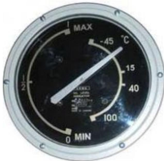
**ПТЭ, п.5.3.12. При номинальной нагрузке температура верхних слоев масла должна быть (если заводами-изготовителями не оговорены иные температуры) у трансформатора и реактора с охлаждением ДЦ - не выше 75 °С, с естественным масляным охлаждением М и охлаждением Д - не выше 95 °С; у трансформаторов с охлаждением Ц температура масла на входе в маслоохладитель должна быть не выше 70 °С.**
