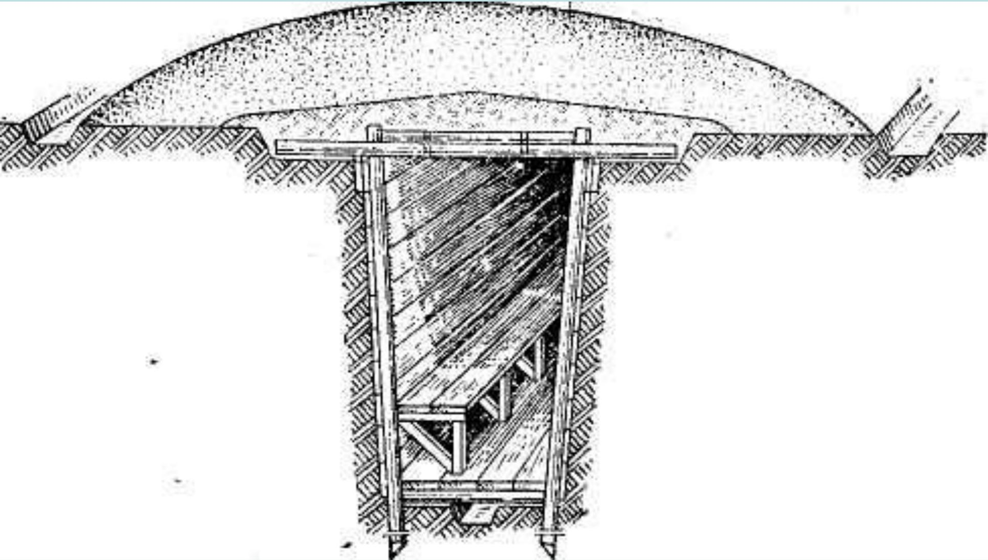
**Рис. 8. Общий вид перекрытой щели (в разрезе)**
