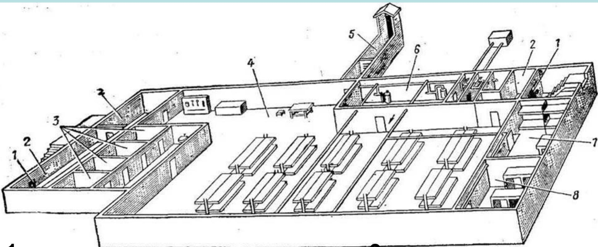
1-защитно-герметические двери; 2-шлюзовые камеры (тамбуры); 3-санитарно-бытовые отсеки; 4-основное помещение для размещения людей; 5-галерея и оголовок аварийного выхода; 6-фильтро-вентиляционная камера; 7-кладовая для продуктов питания; 8-медицинская комната (помещения 7 и 8 могут не устраиваться)
