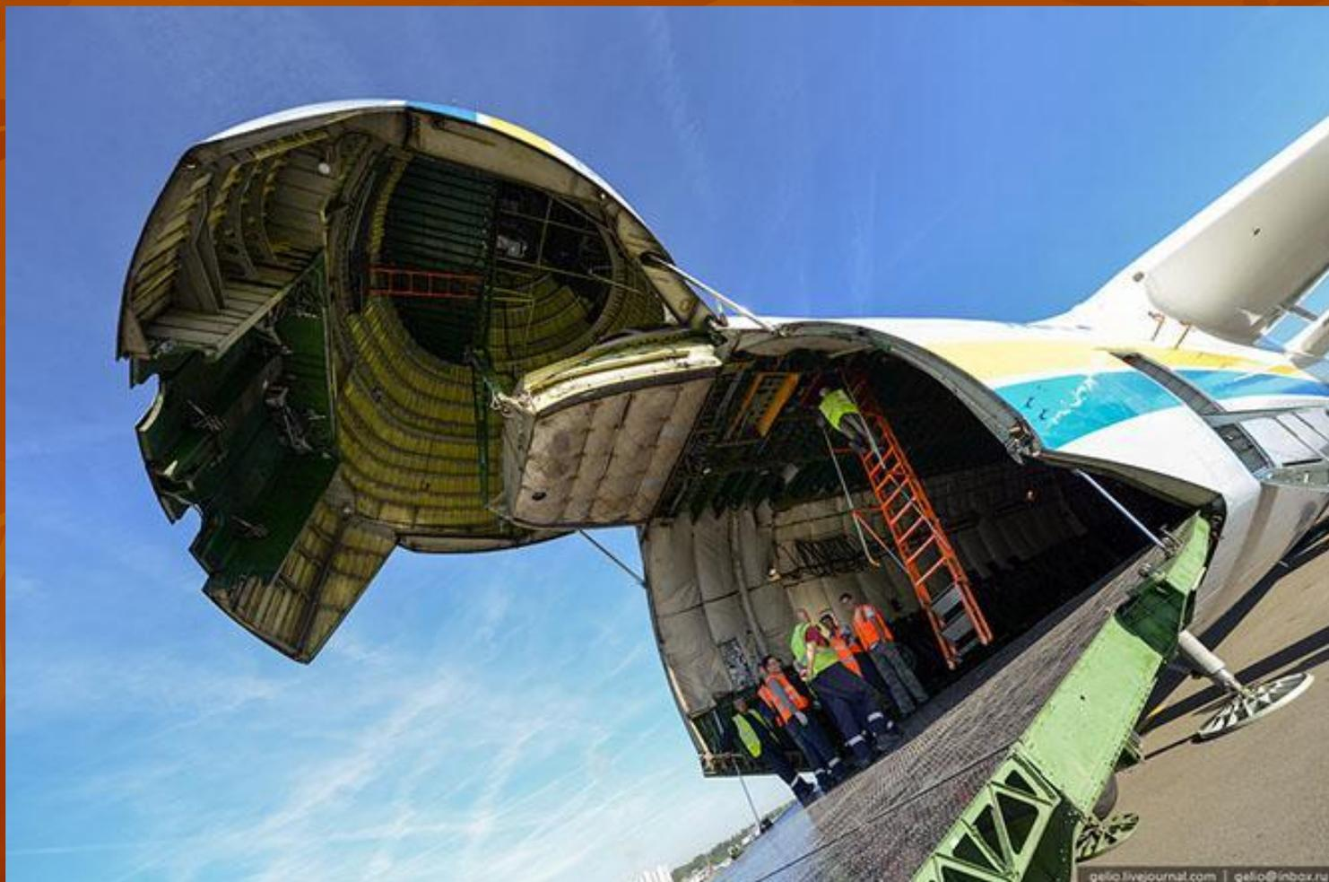
Для обеспечения безопасного выполнения полета, центр тяжести самолета с грузом должен находиться в определенных пределах по его длине. Лоуд-мастер выполняет погрузку в строгом соответствии с инструкцией, после чего второй пилот проверяет правильность размещения груза и докладывает об этом командиру экипажа, который принимает решение о возможности выполнения полета и несет за это ответственность.
