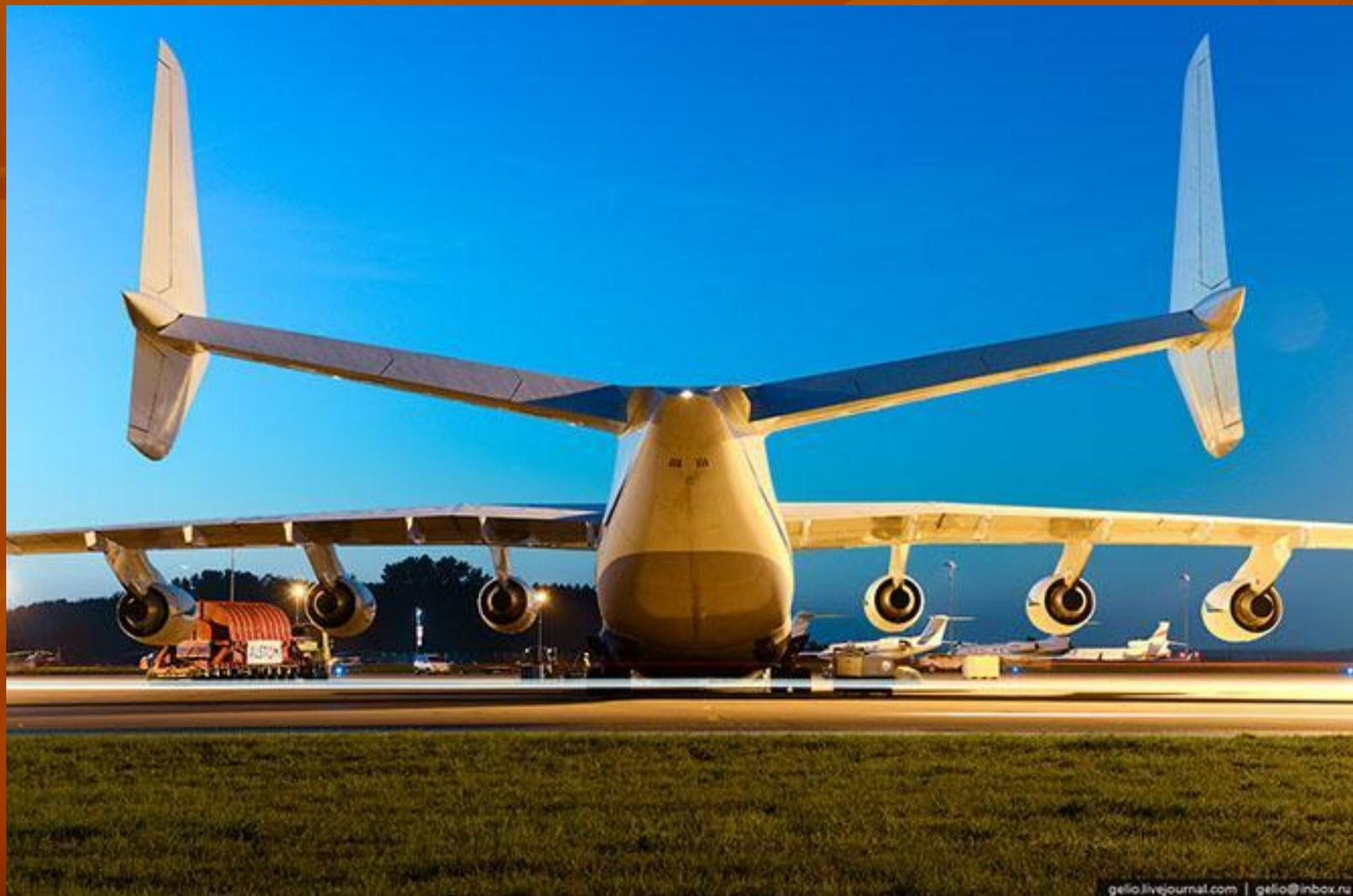
Масса топлива в баках составляет 365 тонн, оно размещается в 13 крыльевых баках-кессонах.
