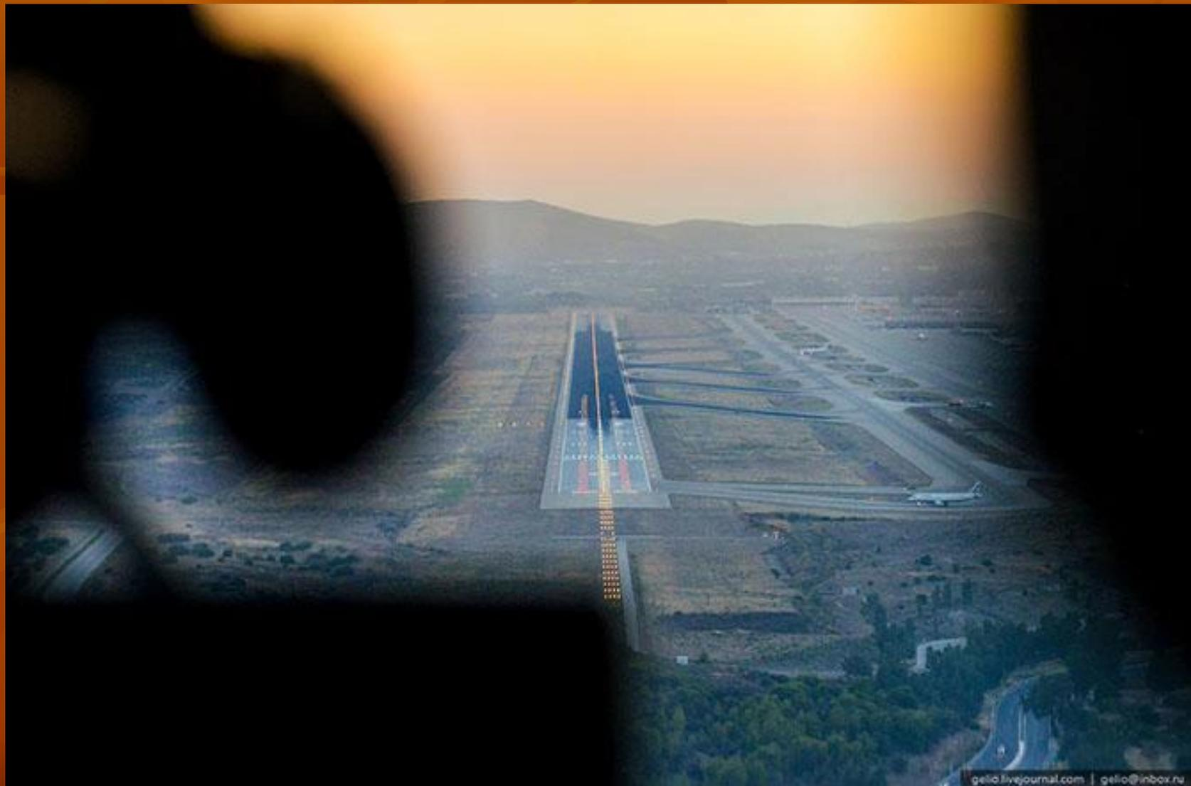
Посадка осуществляется на скорости 295 км/ч с полностью выпущенной механизацией. Допускается касание ВПП при вертикальной скорости 6 м/с. После касания ВПП, сразу переключается реверс тяги на двигателях со 2 по 5, а 1 и 6 оставляют на малом газу. Торможение шасси осуществляется на скорости 140-150 км/ч до полной остановки самолета.
