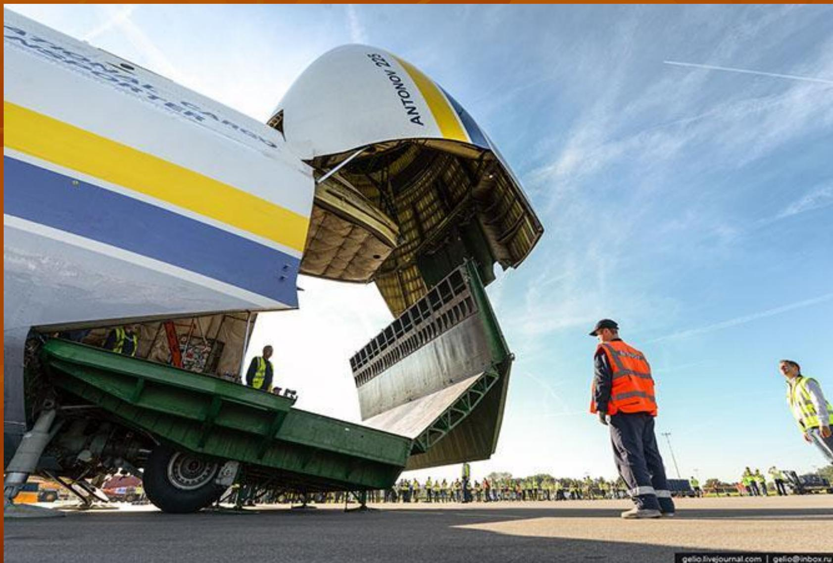
Для раскладывания рампы самолет осуществляет, так называемый «поклон слона». Передняя стойка шасси отклоняется вперед, а вес самолета переносится на вспомогательные опоры, которые установлены под передним порогом грузовой кабины.
