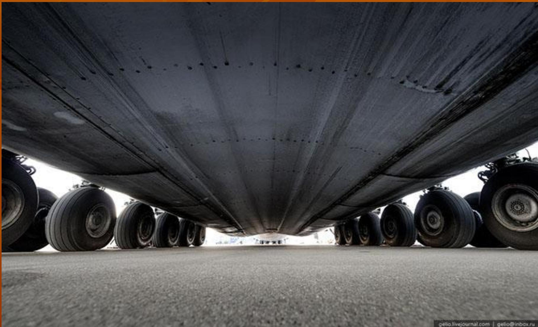
На носовой стойке – колеса размерами 1120 x 450 мм, а на главной – колеса размерами 1270 x 510 мм. Давление внутри составляет 12 атмосфер.
