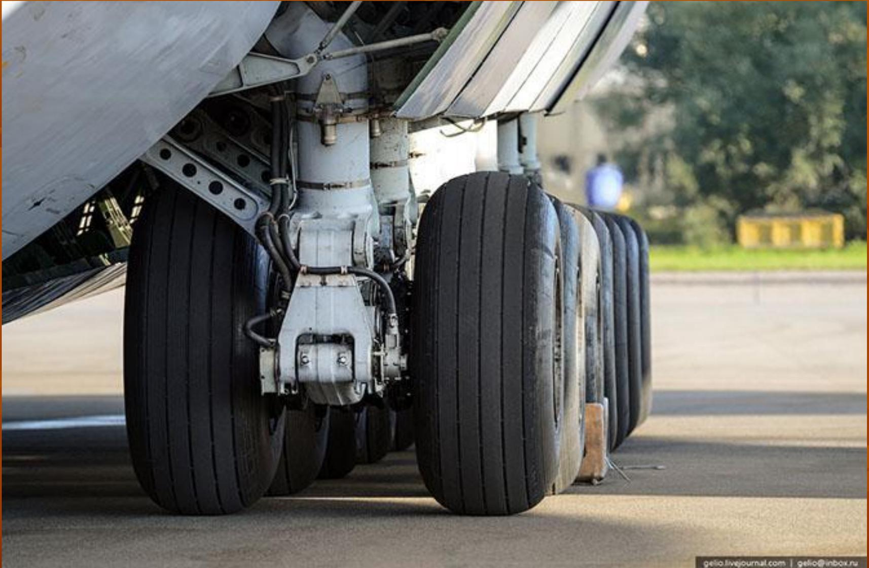
Колеса требуют замены через каждые 90 посадок. Шины для «Мрии» производят на Ярославском шинном заводе. Цена одной шины составляет около \$ 1000.
