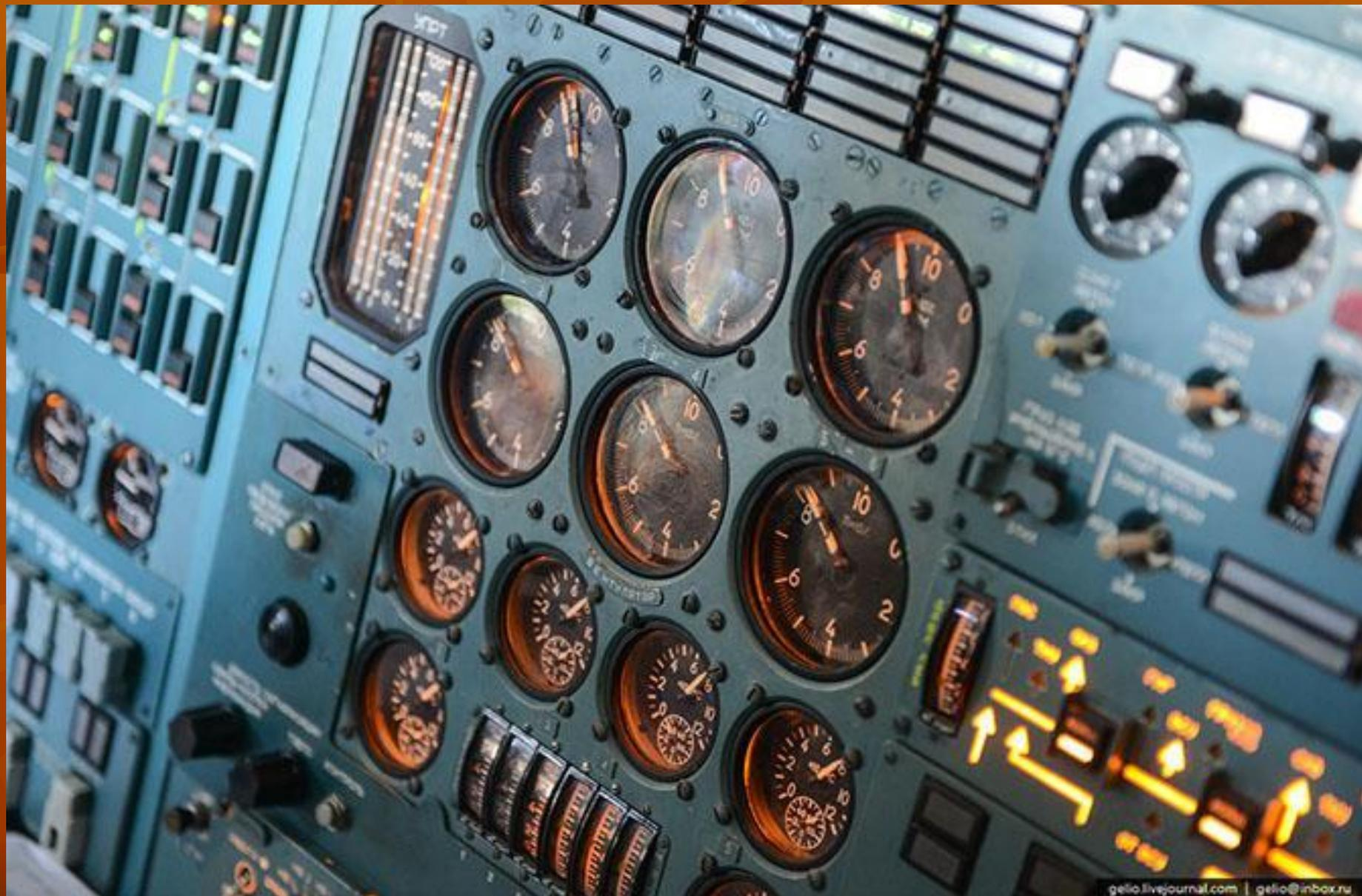
Приборная доска инженера по авиационному оборудованию. Здесь размещены органы управления и приборы контроля системы электроснабжения самолета и кислородной системы.
