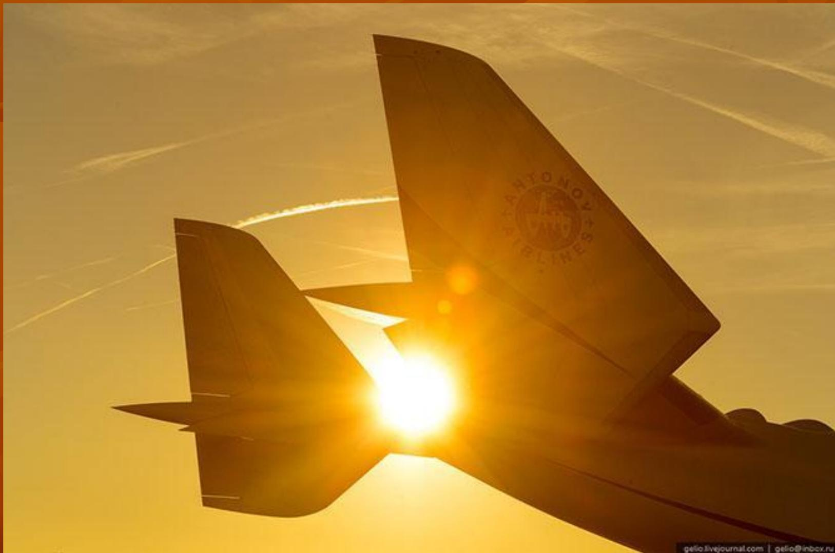
Образование спутной струи от закреплённого наверху самолета крупногабаритного груза потребовало установить хвостовое оперение двухкилевым, чтобы избежать аэродинамического затенения.
