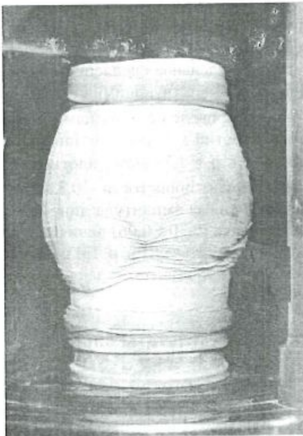
Рис. 2.3. Образец песчаного грунта после испытания
