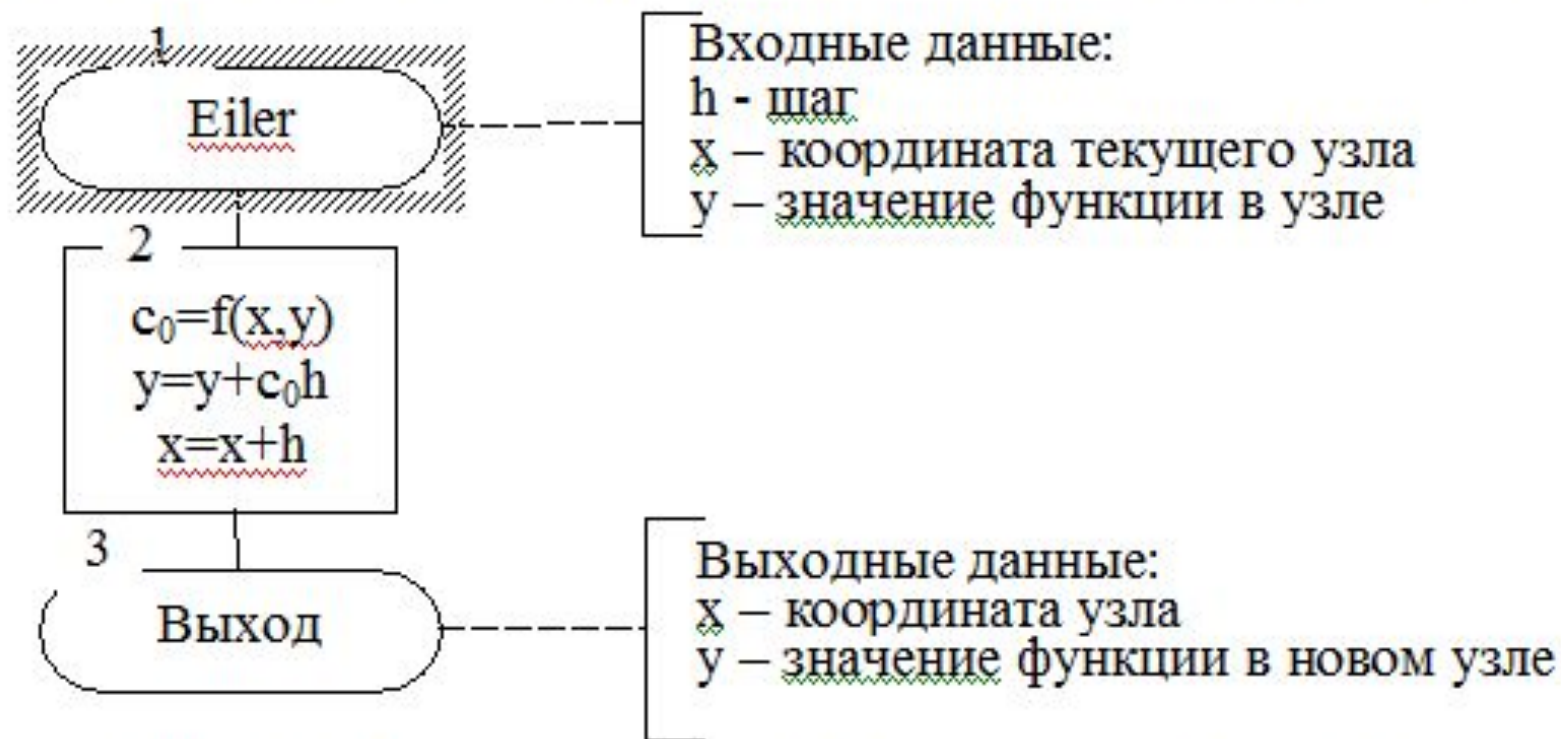
Рис. 7.2. Алгоритм расчета новой точки методом Эйлера:
