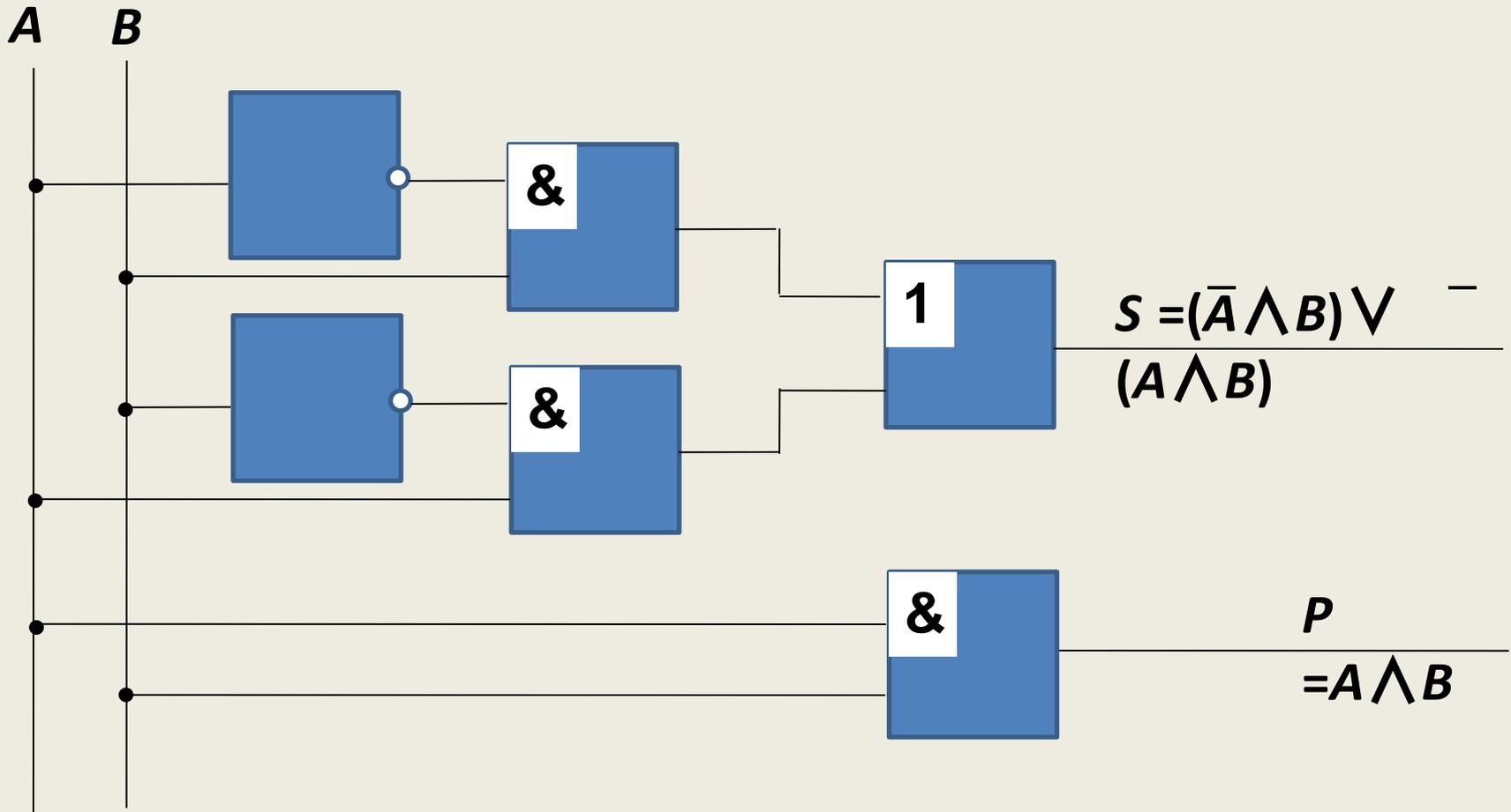
**Пример 3 (самостоятельно).** Логическая функция  $F$ , задана схемой. Записать для этой функции логическое выражение.
