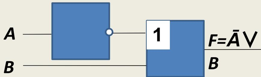
Таким образом, схему логической функции  $F$  (импликации) описывают инвертор и дизъюнктор.
