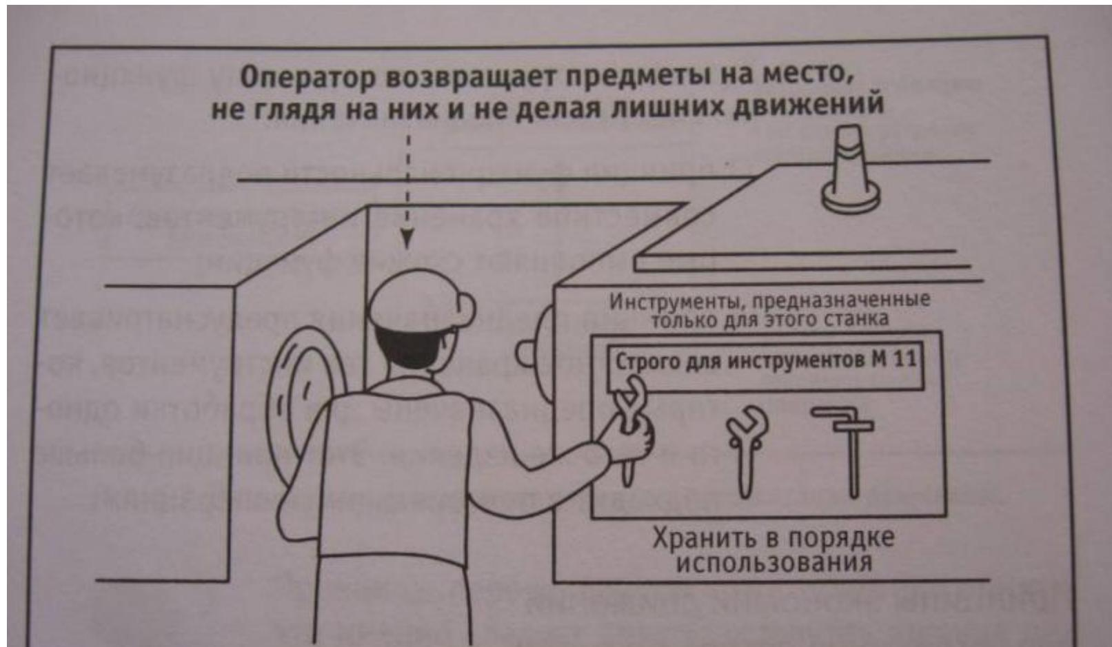
Размещаем инструменты в порядке использования
