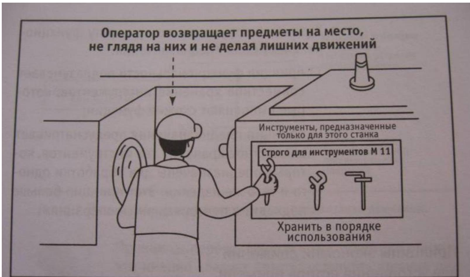
Размещаем инструменты в порядке использования
