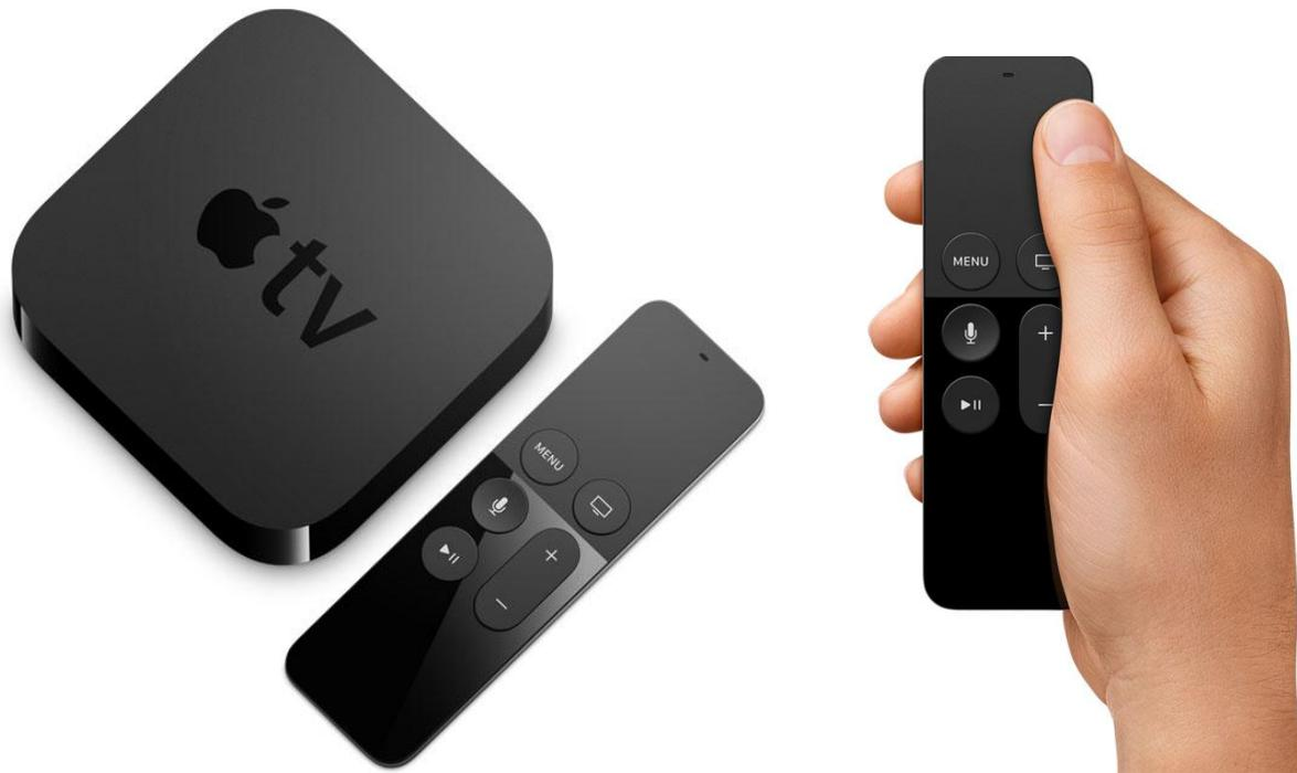
Внешне устройство изменилось незначительно — разве что стало немного выше. В новой модели отсутствует оптический аудиовыход, но по-прежнему присутствуют разъемы HDMI, Ethernet и micro-USB Type-C, используемый в сервисных целях. Новая Apple TV использует однокристальную систему Apple A8 — такую же, как в iPhone 6, в то время как предыдущая модель оснащалась специальной одноядерной версией SoC A5, использовавшейся в iPhone 4S.
